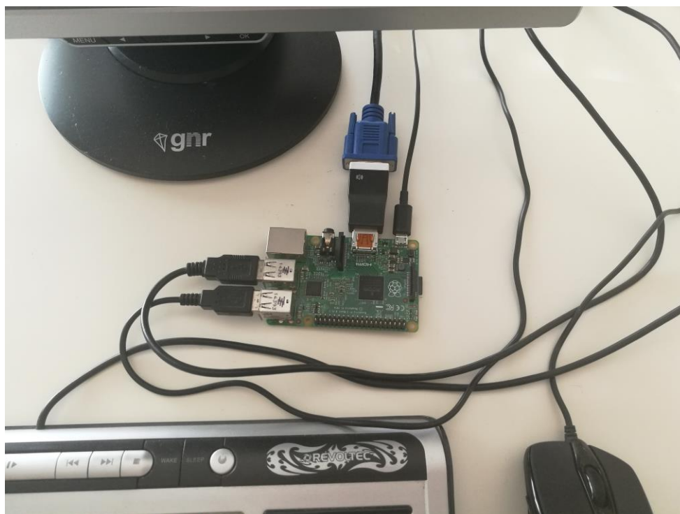
Slika 5.2. Spajanje Raspberry Pi računala
