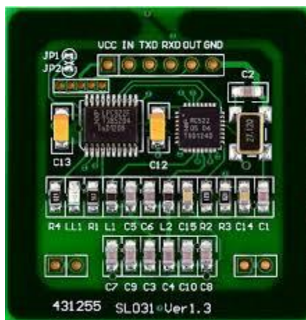
Slika 5.4. RFID modul SL031 Ver1.3 [11]
