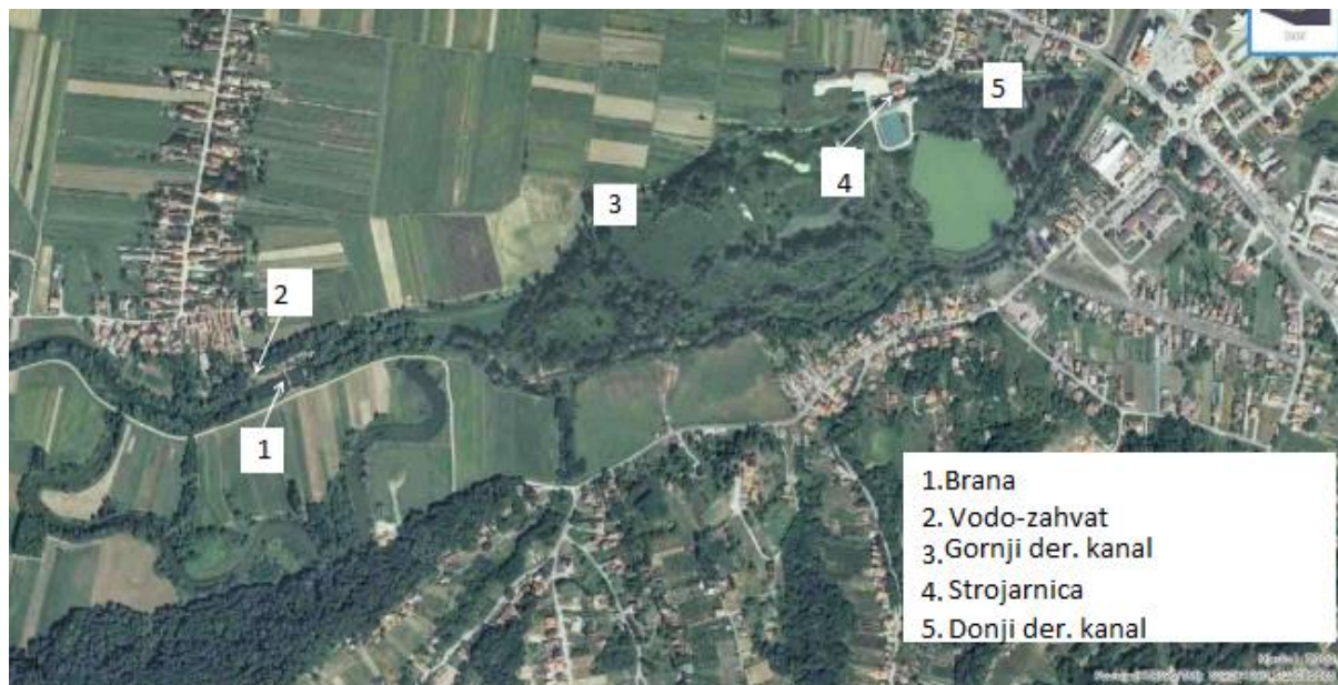
Slika 5. Kartografski prikaz glavnih dijelova postojeće hidroelektrane [21]
