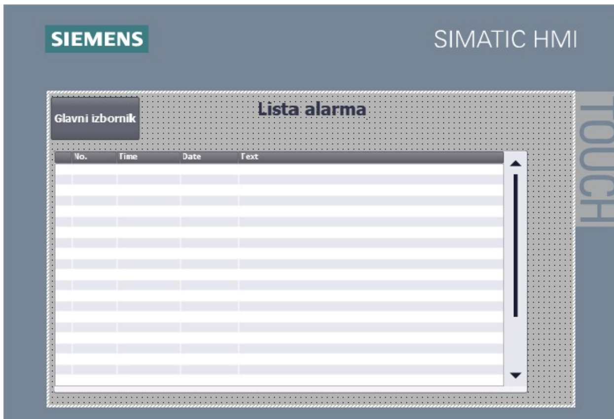
Slika 7.2. Prikaz ekrana „Alarmi“ u TIA portalu
