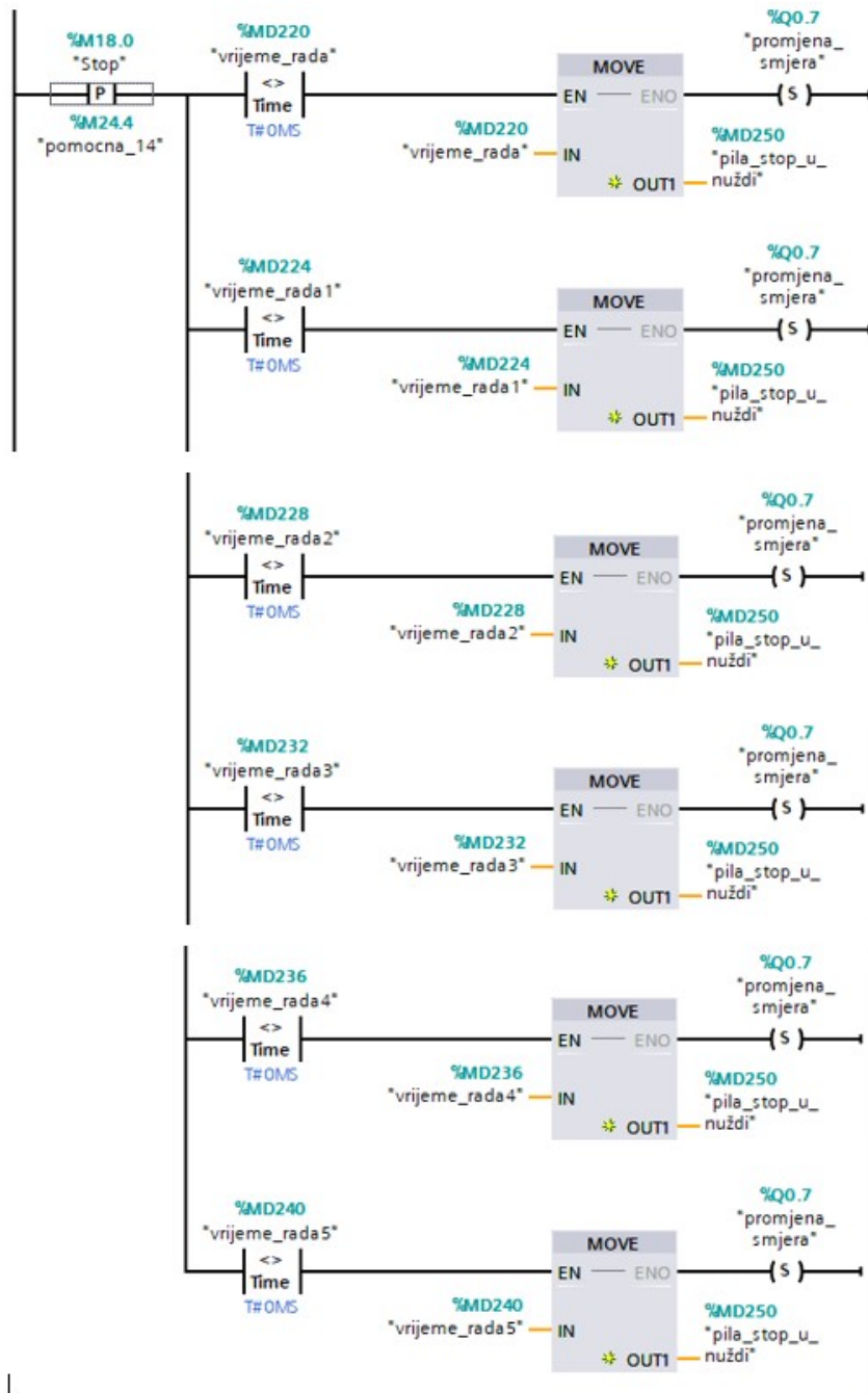
Slika 8.2 Dio programa kod slanja signala za promjenu smjera vrtnje asinkronog motora
