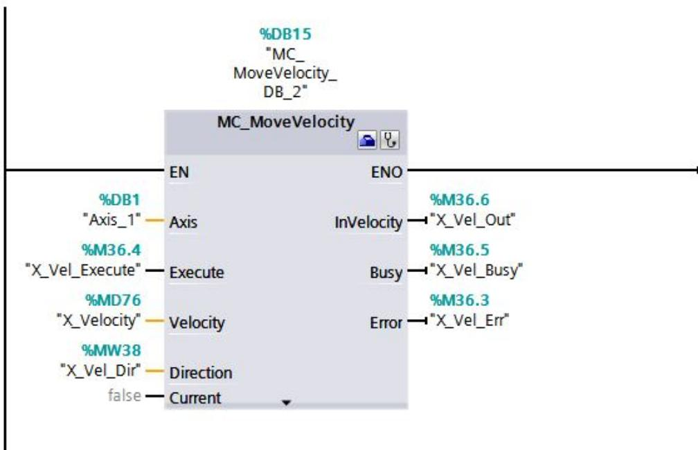
Slika 5.3 MC\_MoveVelocity blok
