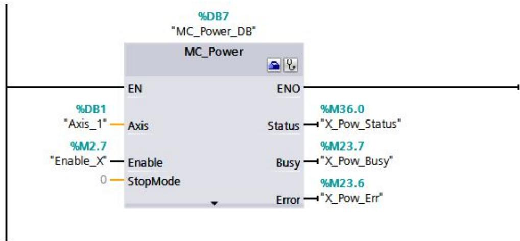
Slika 5.1 MC\_Power blok
