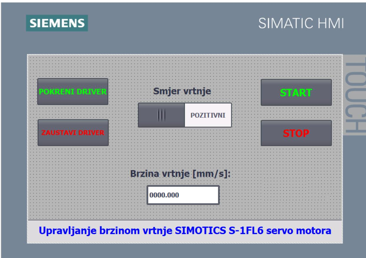
Slika 4.12 Ekran za upravljanje brzinom vrtnje servo motora
