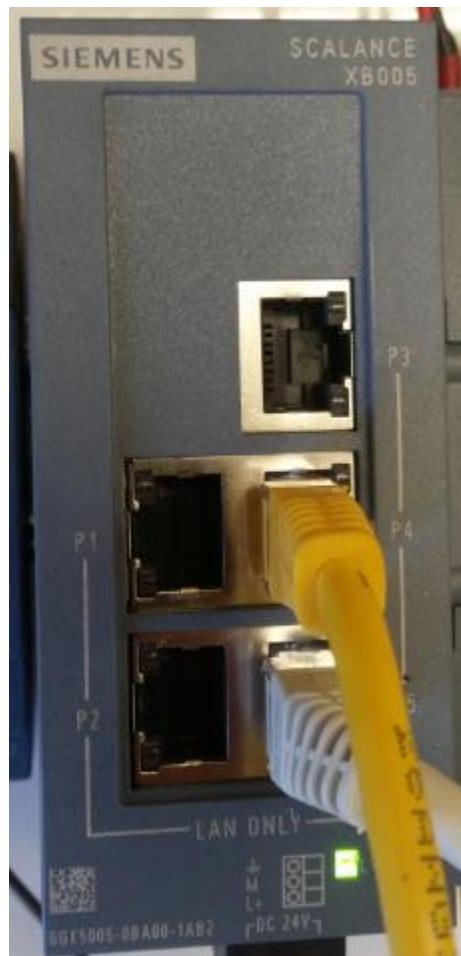
Slika 2.8 Siemens SCALANCE XB005 Ethernet komunikacijski modul
