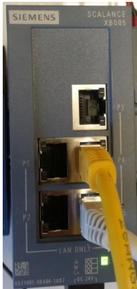
Slika 2.8 Siemens SCALANCE XB005 Ethernet komunikacijski modul
