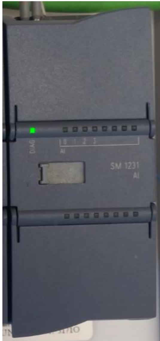
Slika 2.7 Signalni modul analognih ulaza
