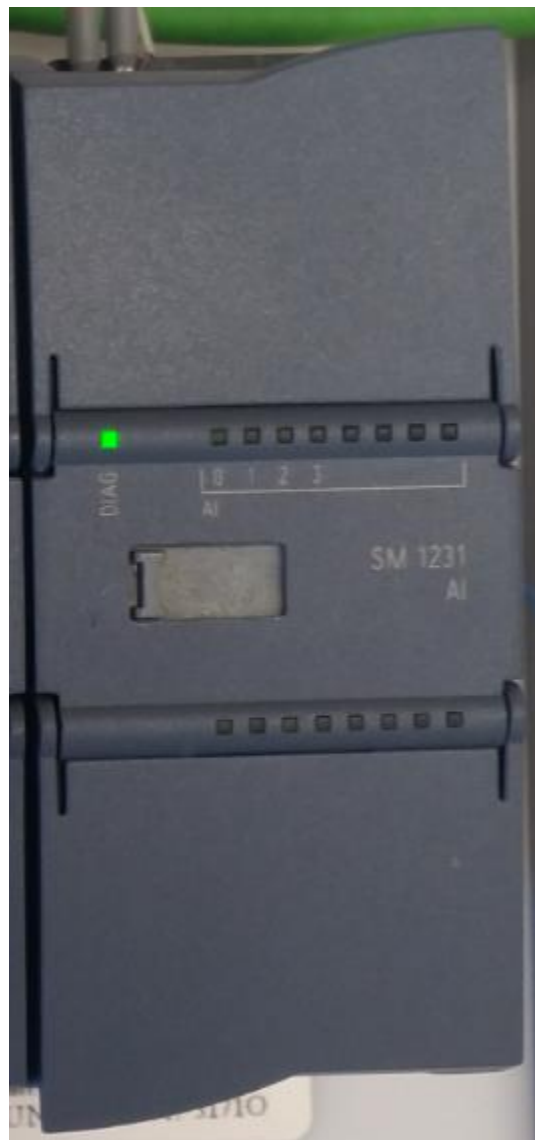
Slika 2.7 Signalni modul analognih ulaza
