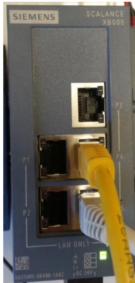
Slika 2.8 Siemens SCALANCE XB005 Ethernet komunikacijski modul
