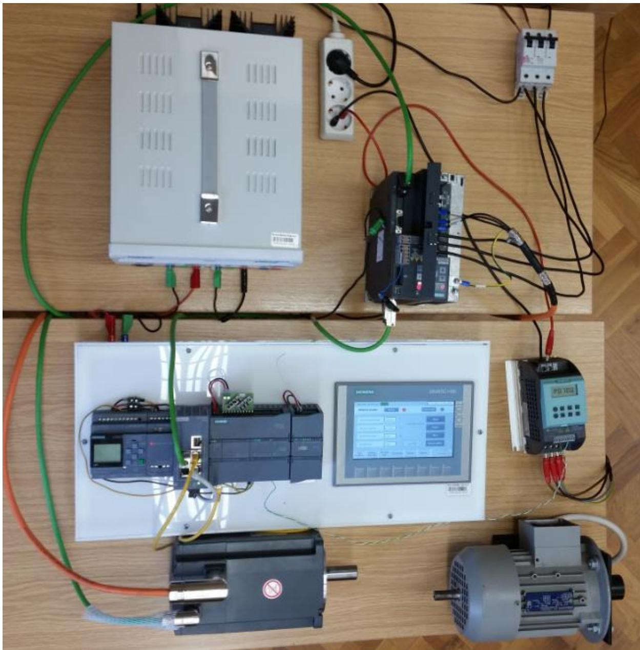
Slika 5.1 Prikaz kompletног pogona s frekvencijskim pretvaračem i asinkronim motorom
