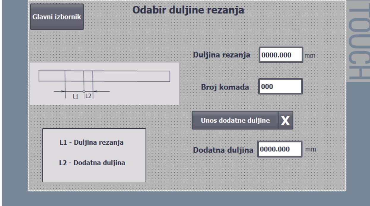
Slika 5.6 Ekran „Odabir duljine rezanja“ sa dodatnom duljinom
