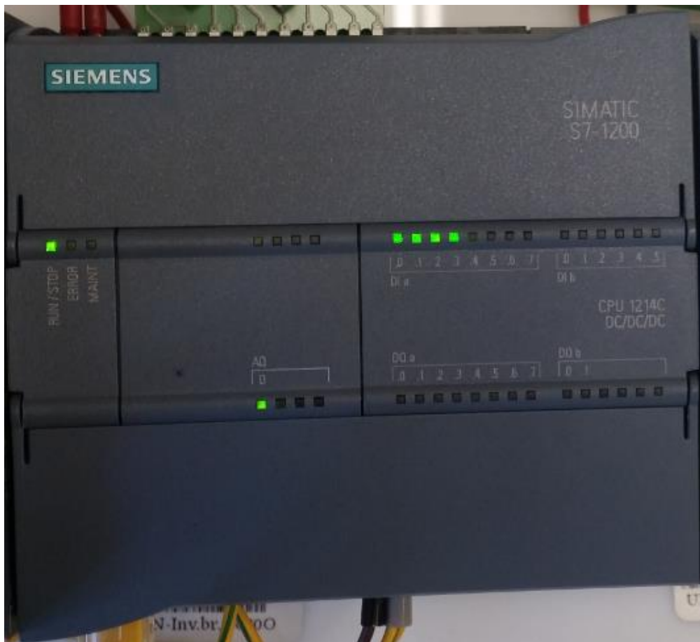
Slika 2.6 Siemens CPU modul S7-1200 - 1214C DC/DC/DC
