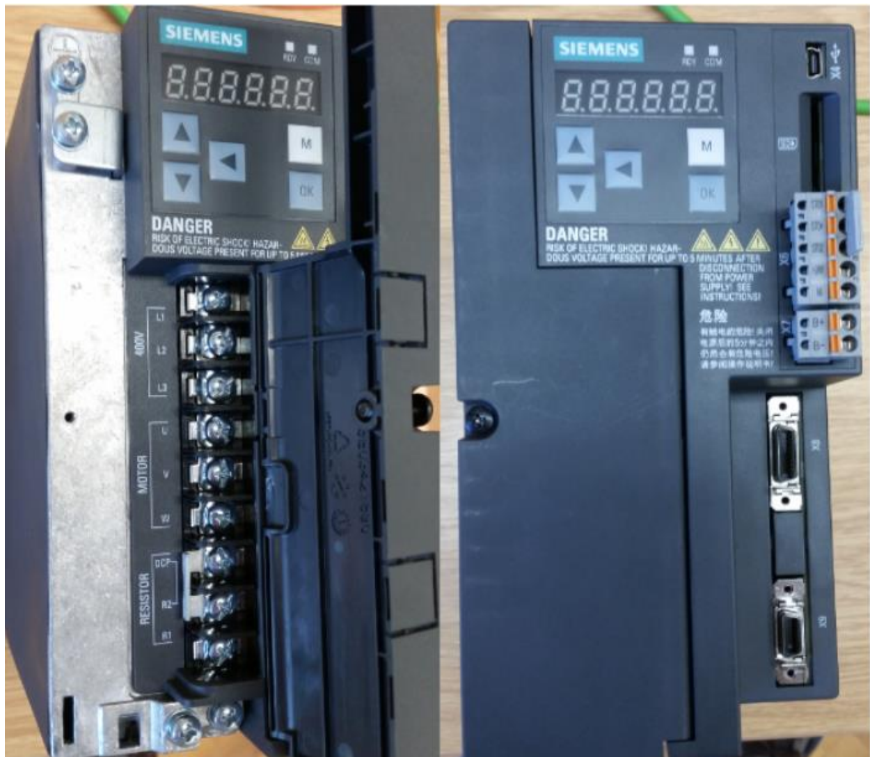
Slika 4.6 Siemens SINAMICS V90 servo driver
