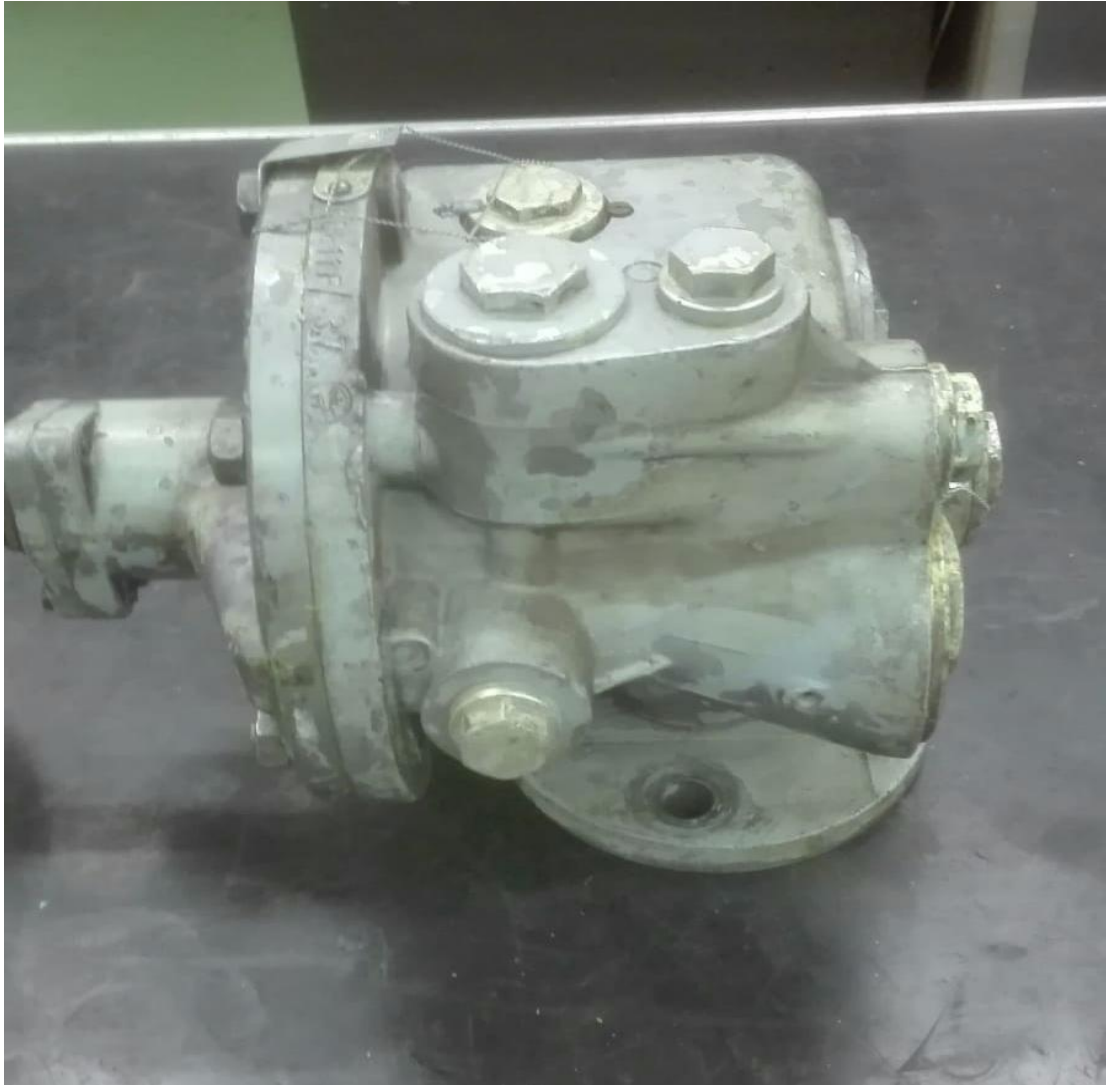
Slika 7: Rasporednik zračne kočnice Est4e [7]
