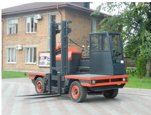
Slika 4. Bočni viličar Linde
