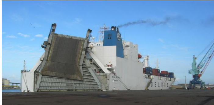
Slika 7.1. RO-RO tehnologija transporta
