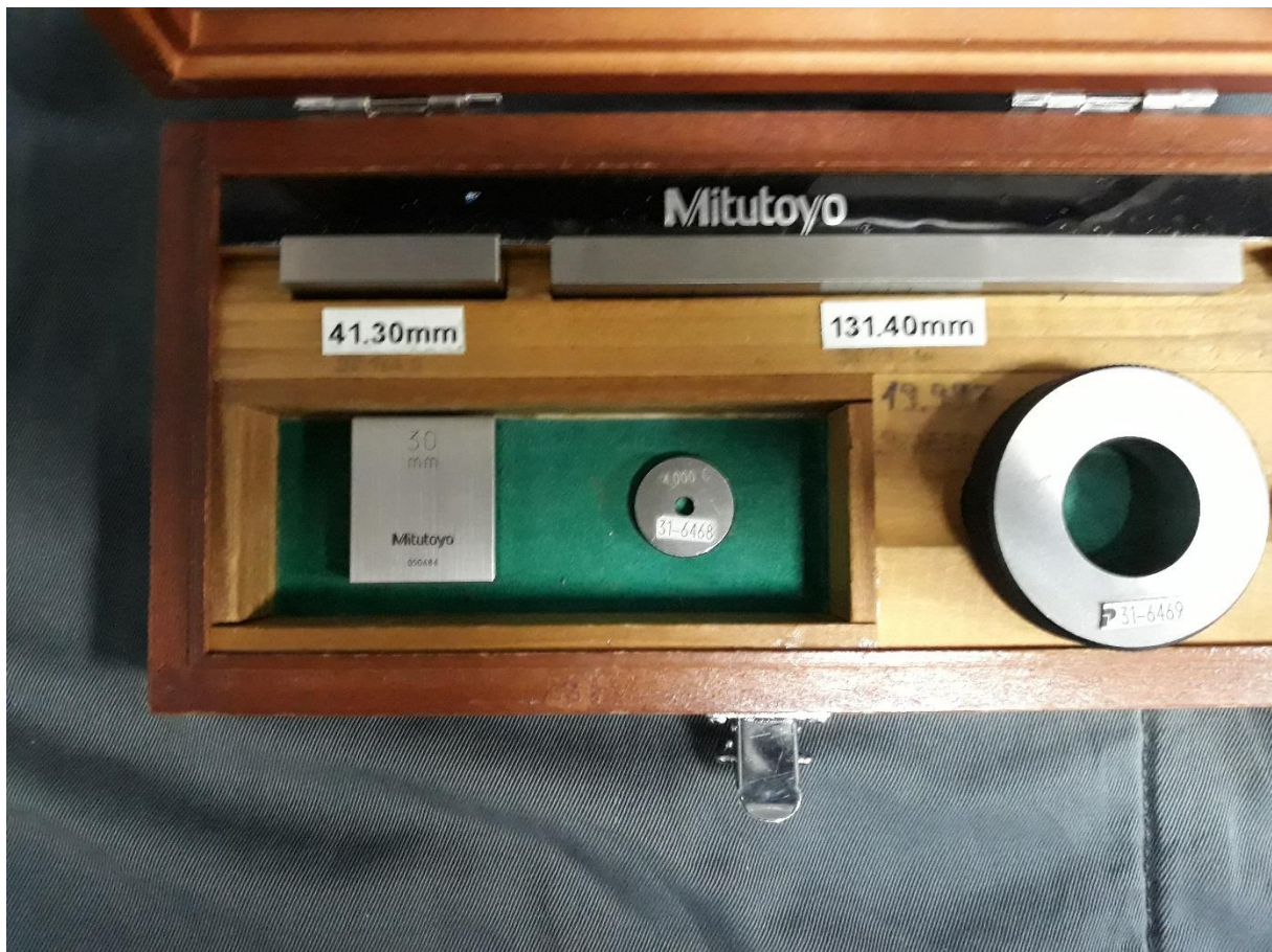
Slika 31. Set za kalibraciju pomičnih mjerila 0 - 150 mm
