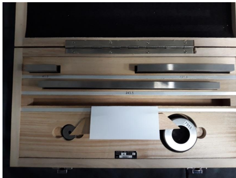
Slika 32. Set za kalibraciju pomičnih mjerila 0 - 300 mm BN 0005
