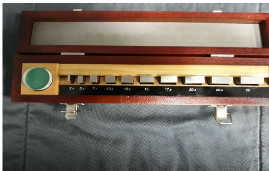
Slika 26. Set za kalibraciju mikrometra BN 0001
