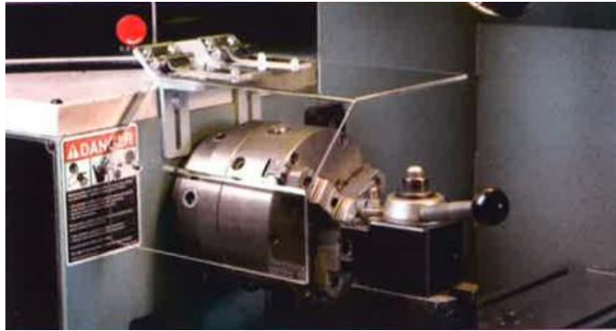
Slika 5.27 Prozirna plastična zaštita oko stezne glave[1]
