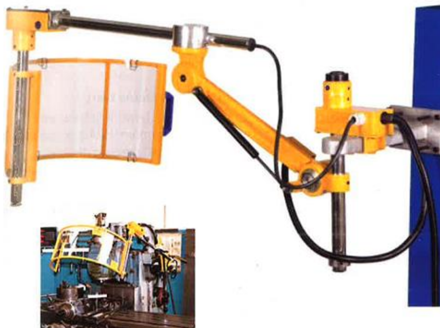
Slika 3.2 Automatska zaštitna naprava [1]
