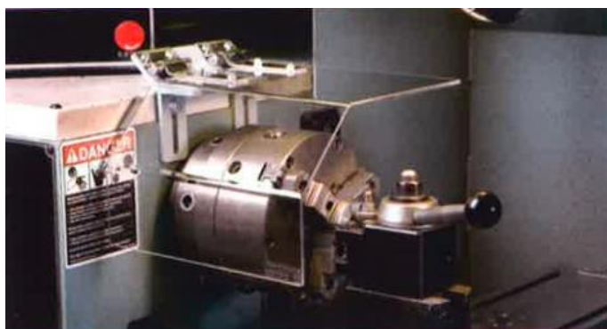
Slika 5.27 Prozirna plastična zaštita oko stezne glave[1]
