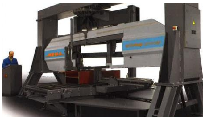
Slika 3.4 Zaštitna naprava za daljinsko upravljanje [1]
