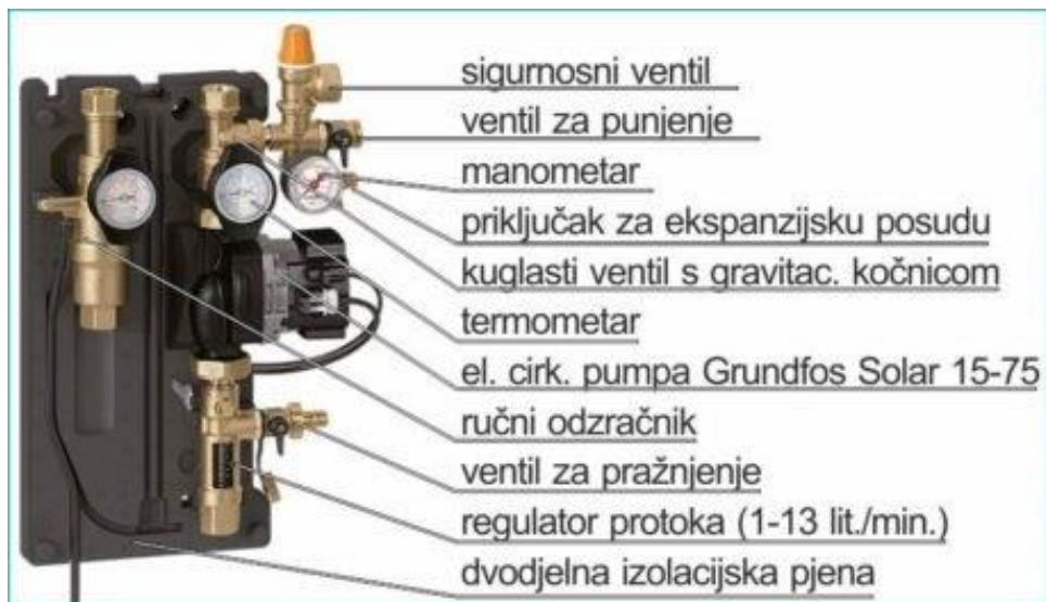
Slika 2.8. Solarna pumpna grupa [5]
