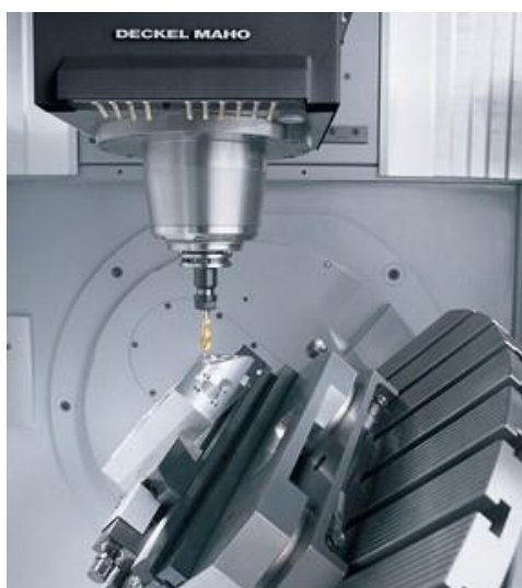
Slika 13 Obrada komada na okretno-nagibnom stolu [10]
