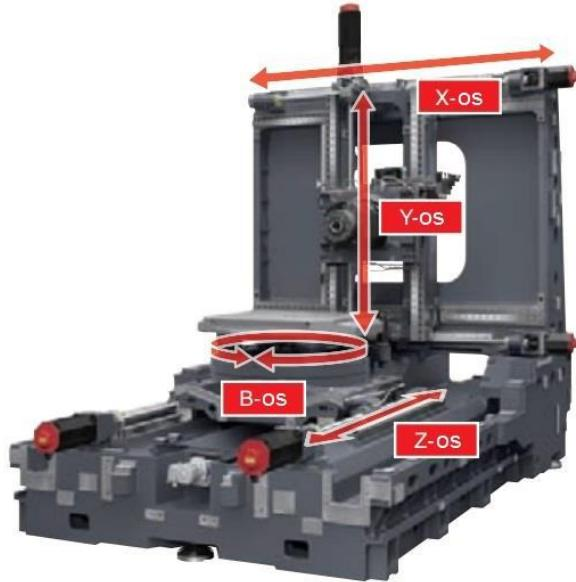
Slika 9 Horizontalni glodaći obradni centar [9]
