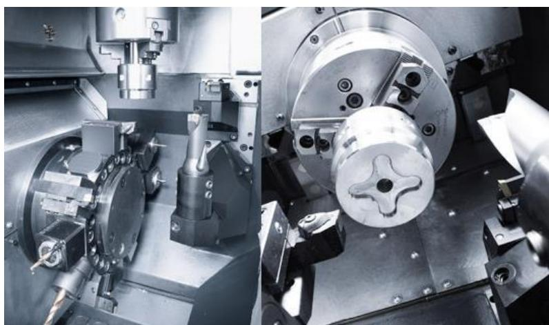
Slika 7 Proizvodni vertikalni tokarski obradni centar [8]
