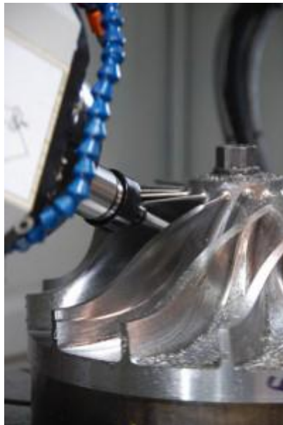
Slika 11 Obrada turbine na stroju s okretnim stolom i nagibnom glavom [10]
