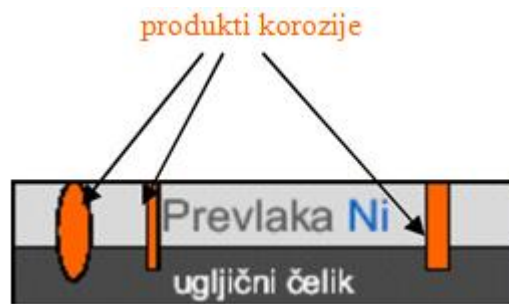
Slika 18. Katodna prevlaka nikla na čeliku[9]
