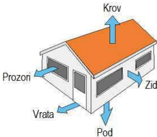
Slika 4.1 Ilustracija prijelaza topline iz prostorije
