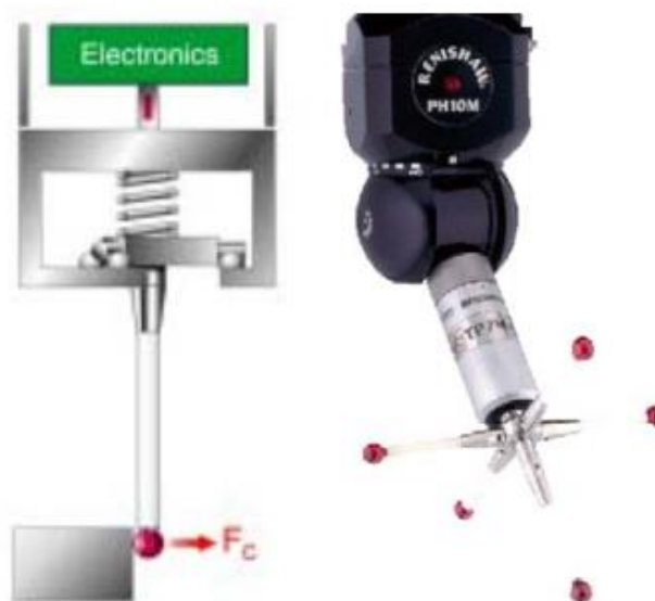
Slika 5.14 Sonda sa mjernim trakama (Renishaw TP7M) [3]
