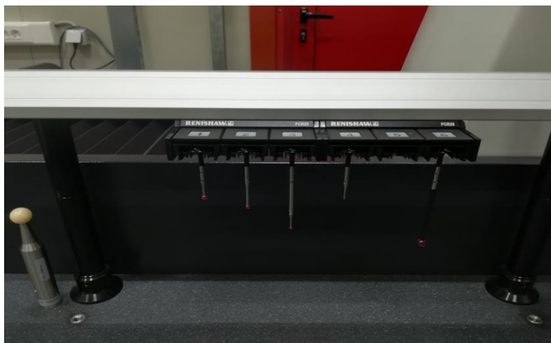
Slika 8.7 Kugla za umjeravanje i stalak sa mjernim ticalima
