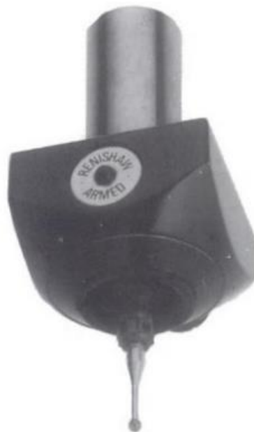
Slika 5.2 Sonda osjetljiva na dodir, 1973.g., Courtesy Renishaw [18]
