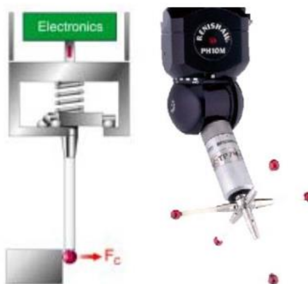
Slika 5.14 Sonda sa mjernim trakama (Renishaw TP7M) [3]
