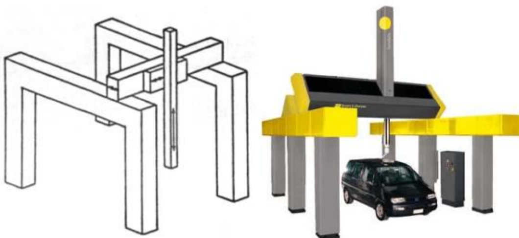
Slika 3.7 Portalna struktura TMU-a [3]
