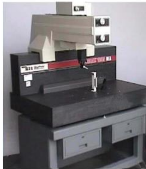
Slika 3.5 Konzolna struktura TMU-a [3]
