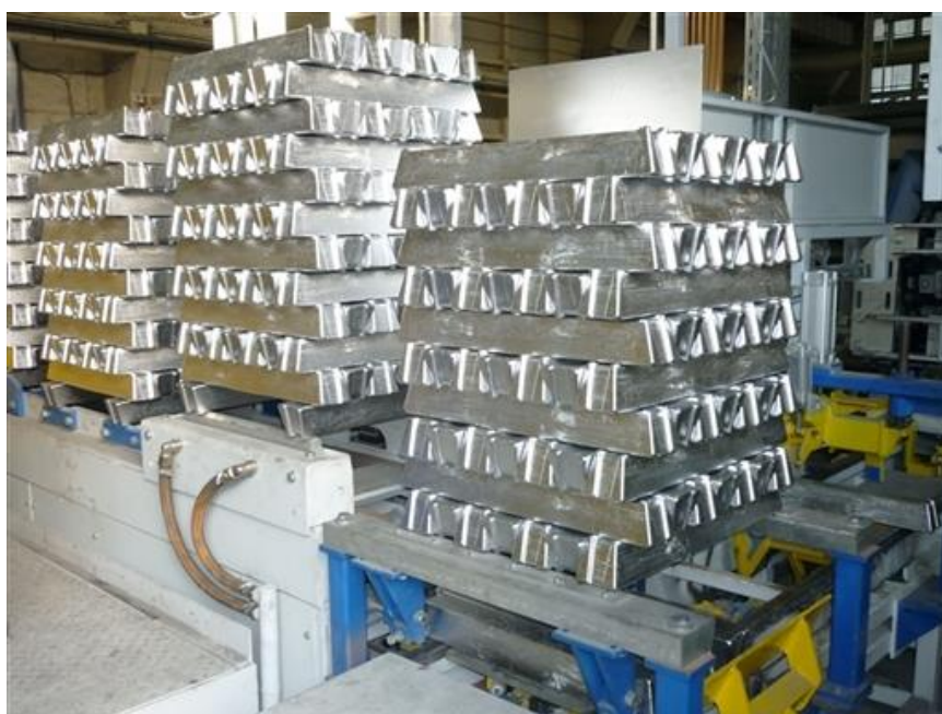
Slika 2.3. Primjer nagomilavanja proizvoda uslijed prekomjerne proizvodnje [2]
