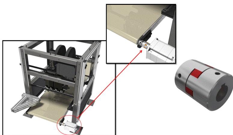
Slika 1. 1 Primjena spojke u proizvodnim pogonima
