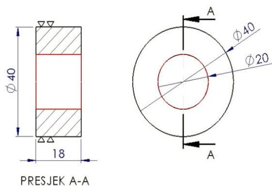
Slika 3. 8 Bušenje provrta ø20
