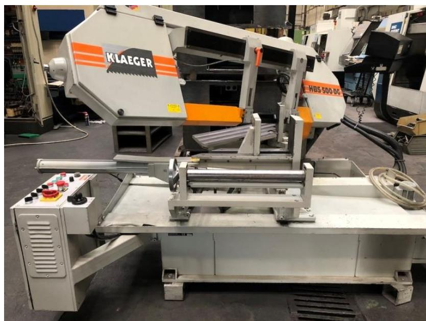
*Slika 3.3 Tračna pila Klaeger*
