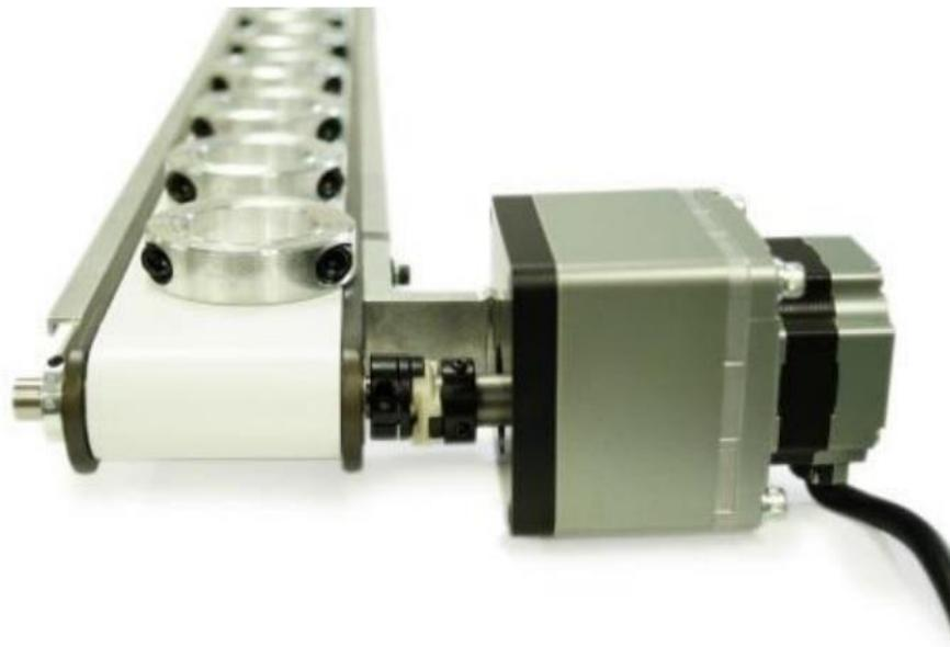
*Slika 1.3 Primjena Oldhamove spojke u proizvodnji*
