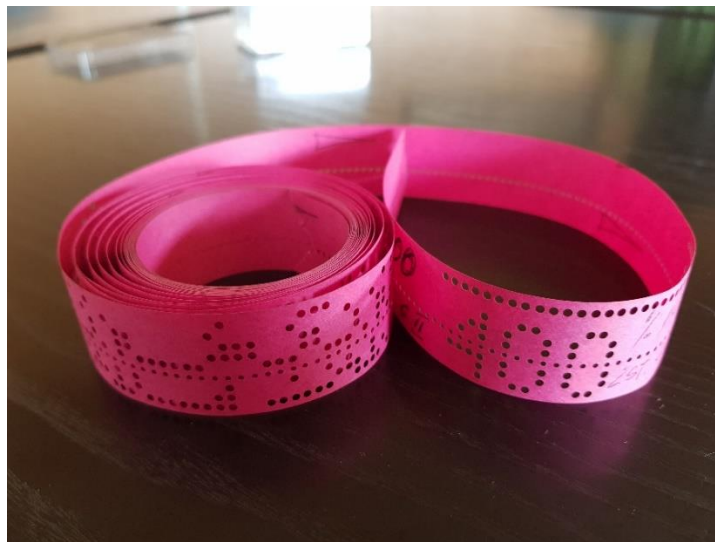
Slika 1-1. Primjer NC trake
