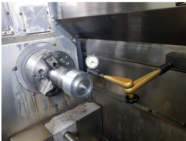
Slika 7-9. Provjera pomoću mjerne ure
