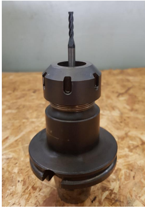
Slika 7-6. Fino ravno glodalo \Phi 4
