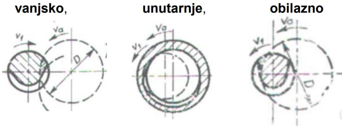
Slika 2.3 Vrste kružnog glodanja [2]
