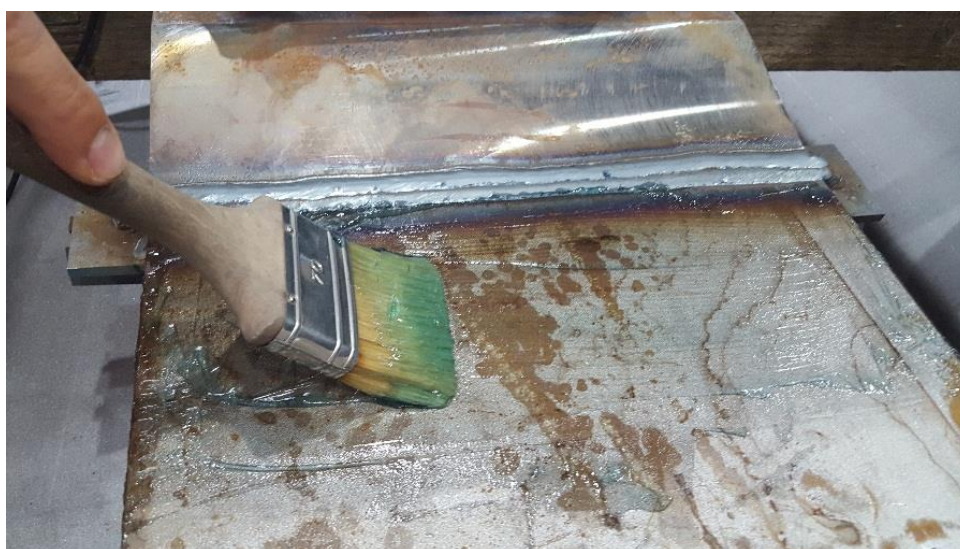
Slika 58: Premazivanje površine gelom
