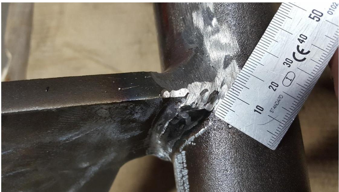
*Slika 86: Označavanje i mjerene dužine greške na zavarenom spoju*
