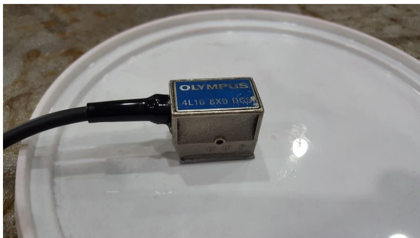
Slika 53: Sonda novije generacije OLYMPUS 4L16-8X9-DGS1-P-2.5 mijenja sve sonde sa (Slika 54)
