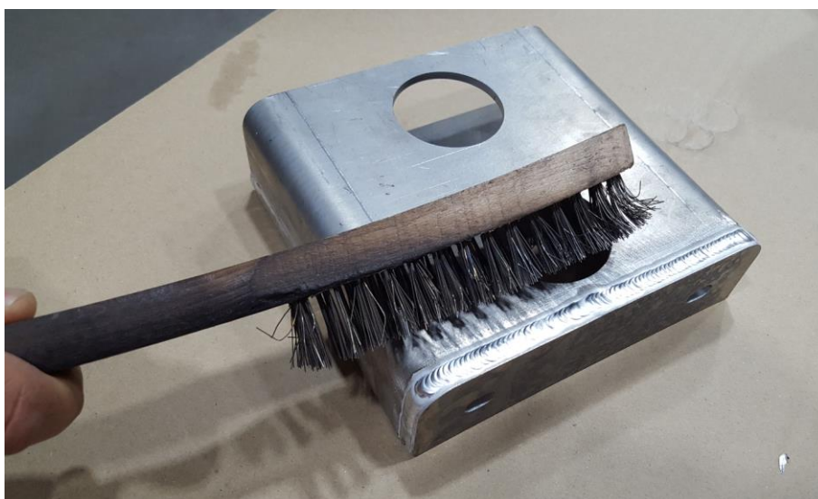
Slika 39: Čišćenje i četkanje komada prije početka ispitivanja
