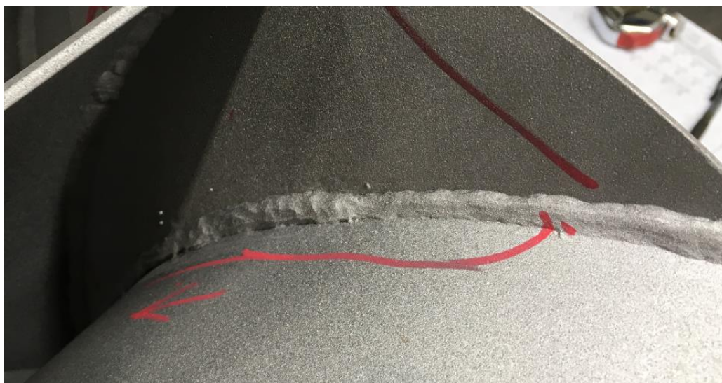
Slika 11: Naljepljivanje utvrđeno vizualnom kontrolom
