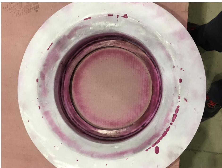
Slika 34: Ispitivanje zavarenog spoja penetrantima (faza prikaza indikacija)
