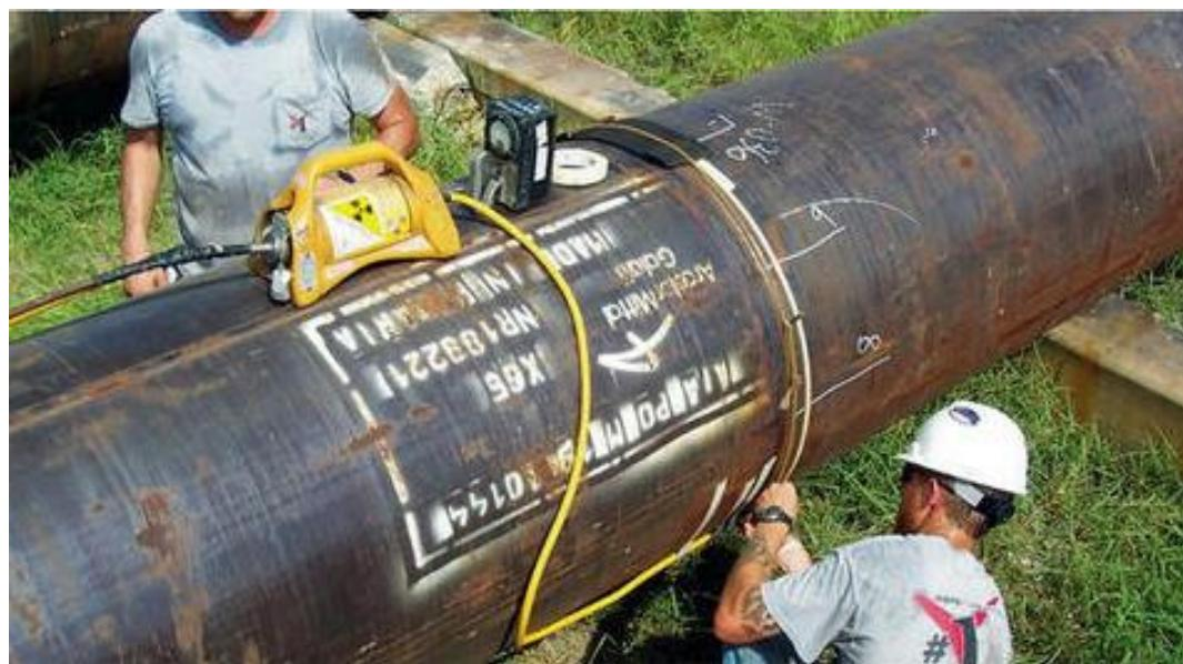
Slika 62: Radiografsko ispitivanje zavara na cjevovodu [21]
