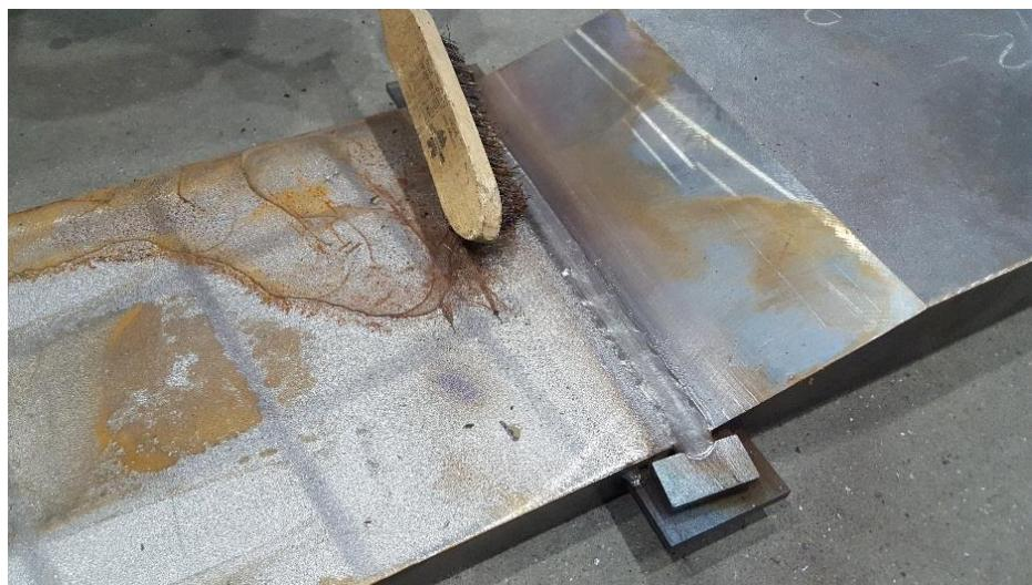
Slika 55: Čišćenje i priprema površine preje ispitivanja
