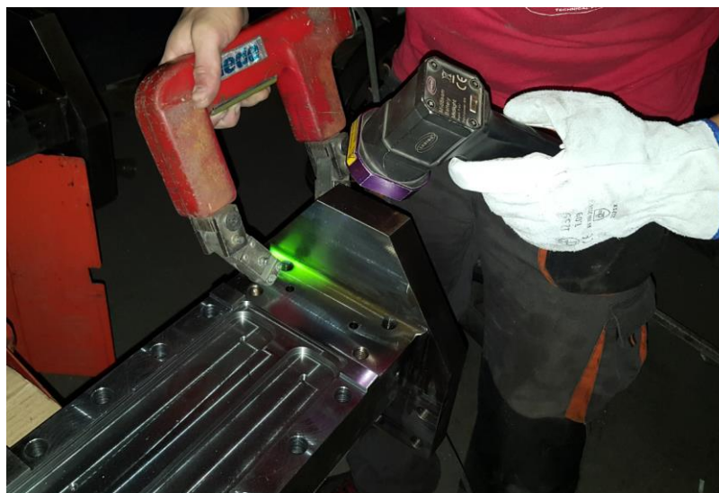
Slika 43: Ispitivanje artikla za rudarsku industriju magnetskom metodom
