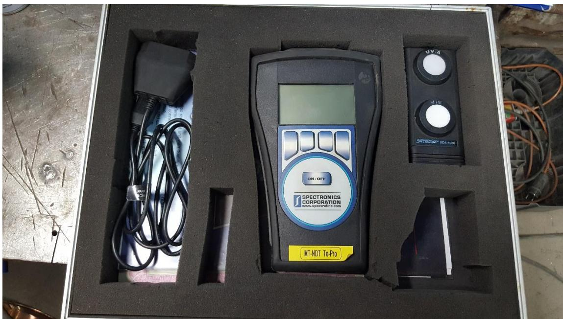
Slika 67: Lux metar SPECTROLINE XRP-3000
