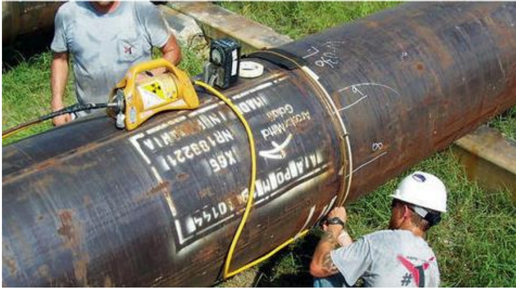
Slika 62: Radiografsko ispitivanje zavara na cjevovodu [21]
