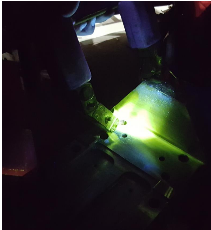
Slika 44: Ispitivanje artikla za rudarsku industriju magnetskom metodom
