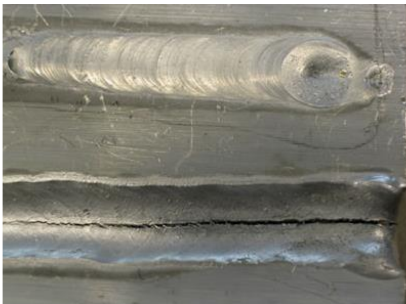
Slika 6: Uzdužno puknuće aluminjskog zavora [14]
