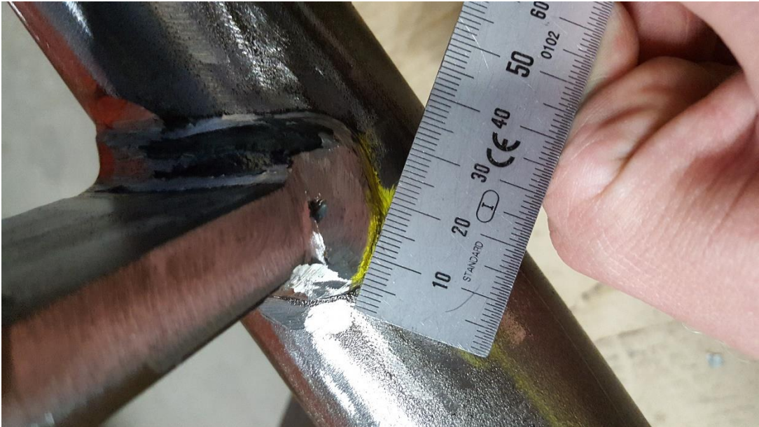
Slika 85: Označavanje i mjerenje dužine greške na zavarenom spoju
