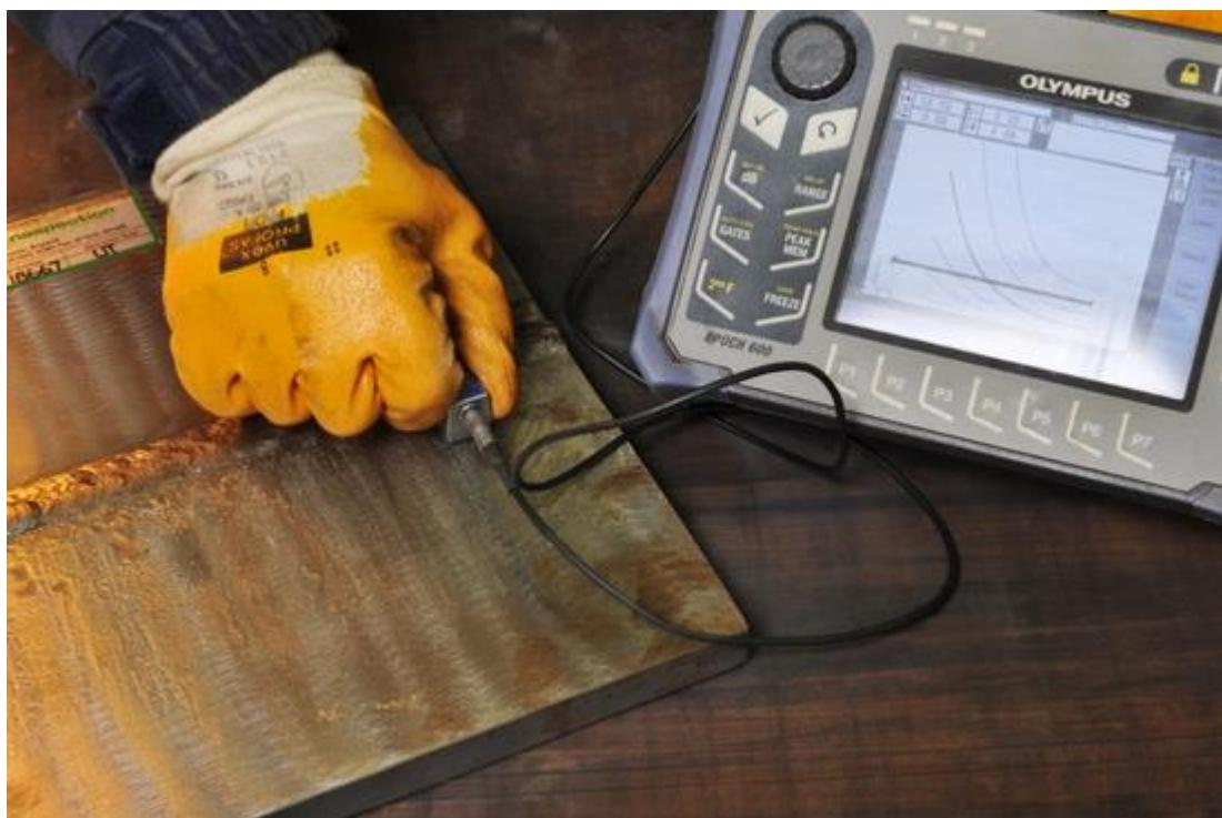
*Slika 16: Ultrazvučno ispitivanje zavarenog spoja [16]*
