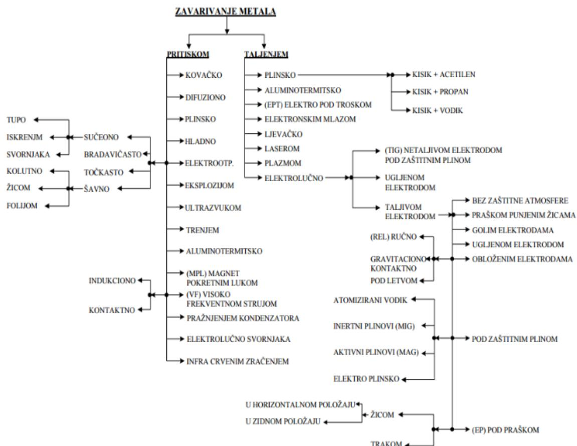
Slika 2: Prikaz podjele postupaka zavarivanja metala [5]
