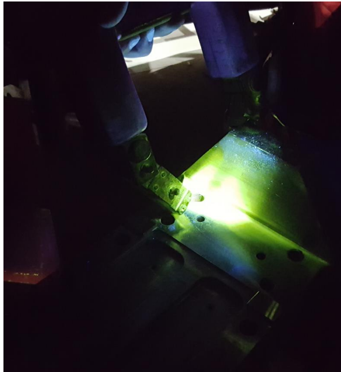
Slika 44: Ispitivanje artikla za rudarsku industriju magnetskom metodom
