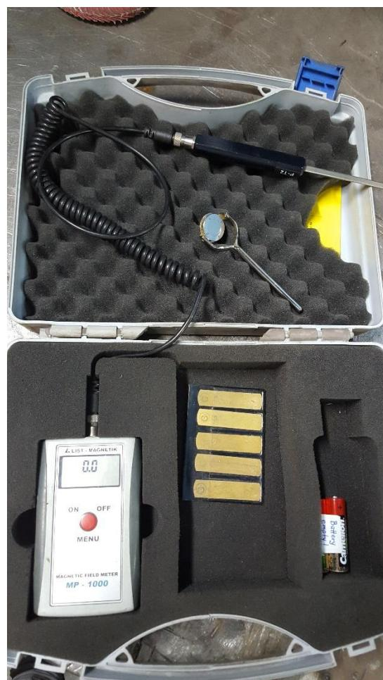
Slika 69: Magnetometar LIST MAGNETIK MP-1000
