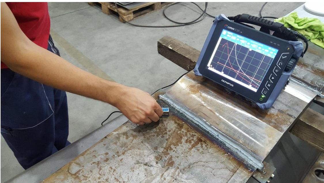
Slika 46 : Ispitivanje zavarenog spoja ultrazvučnom metodom
