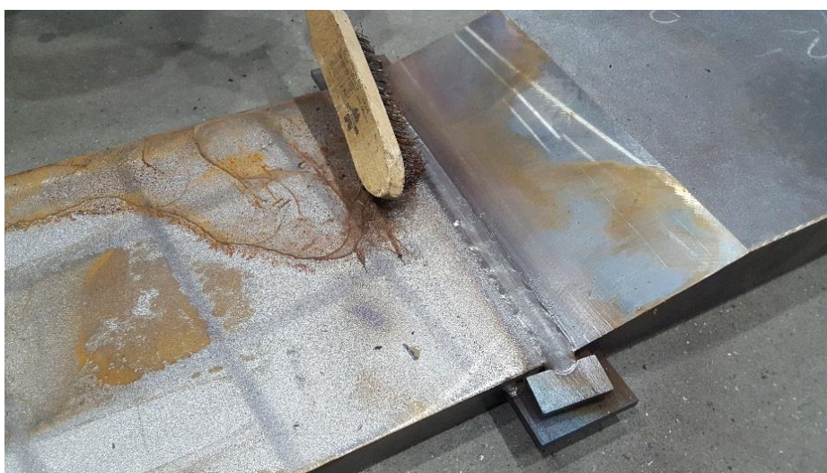
Slika 55: Čišćenje i priprema površine prije ispitivanja
