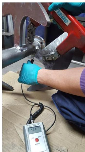
Slika 82: Rezultati mjerenja magnetometrom
