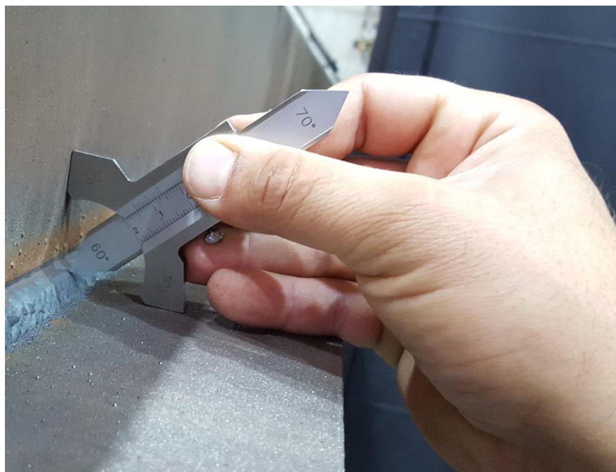
Slika 29: Mjerenje veličine zavarenog spoja
