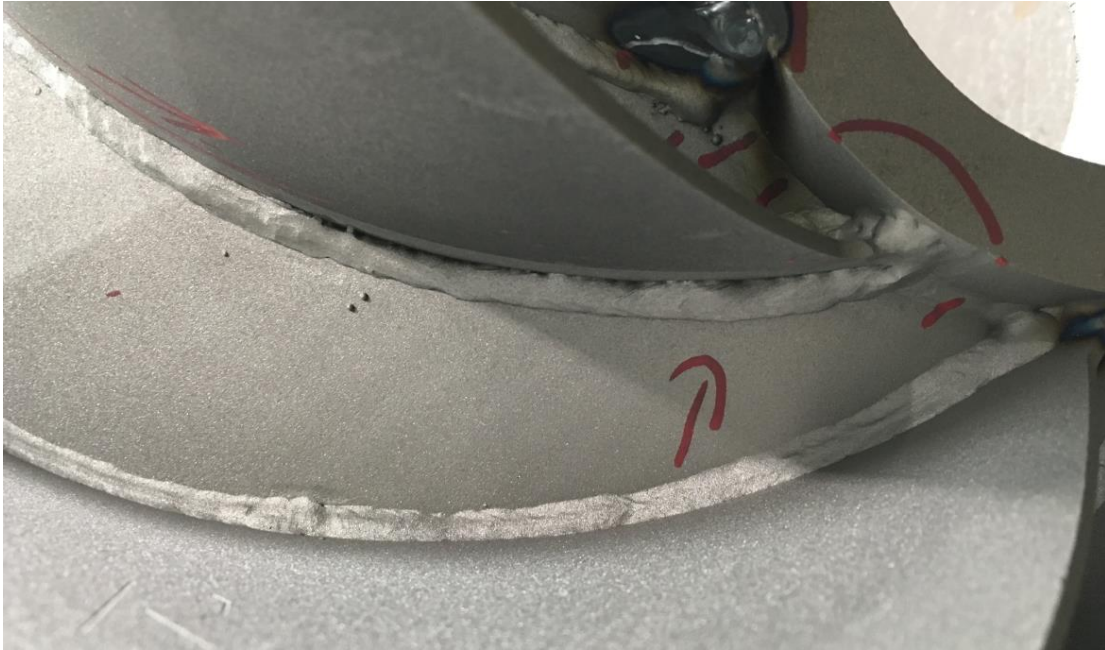
Slika 12: Naljepljivanje utvrđeno vizualnom kontrolom
