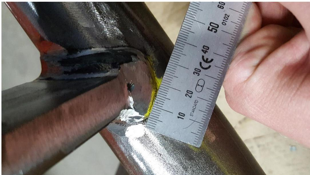
Slika 85: Označavanje i mjeranje dužine greške na zavarenom spoju
