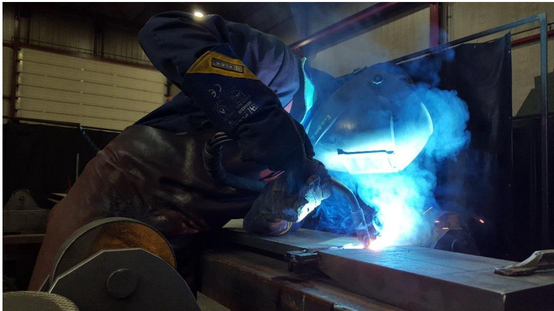
*Slika 3: Prikaz zavarivača koji zavaruje MAG postupkom*
