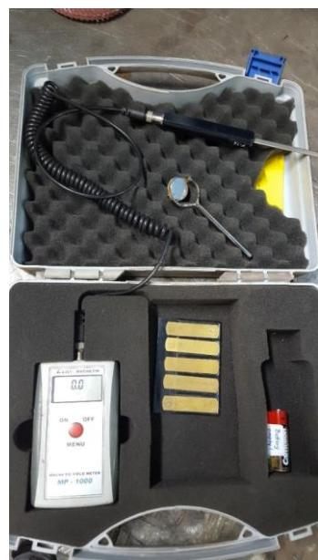
Slika 81: Magnetometar LIST MAGNETIK MP-1000
