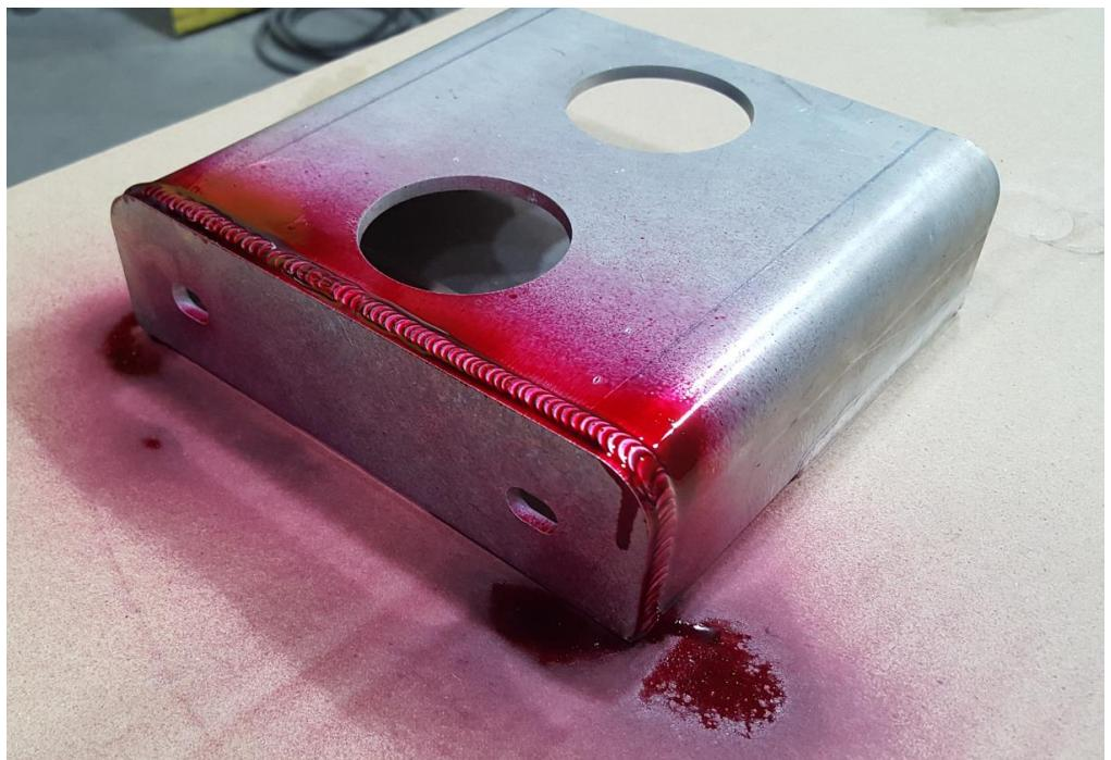
*Slika 40: Nanošenje penetranta*
