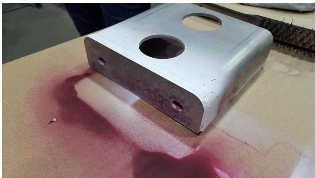
*Slika 41: Nanošenje razvijača s vremenskim odmakom od petnaest minuta*
