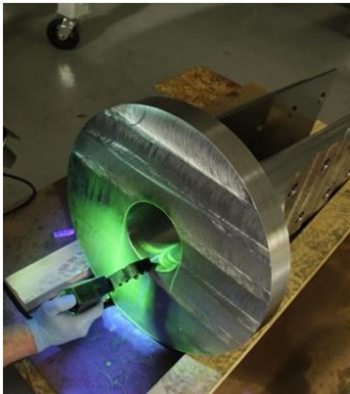
Slika 17: Postupak ispitivanja zavarenog spoja magnetskom metodom
