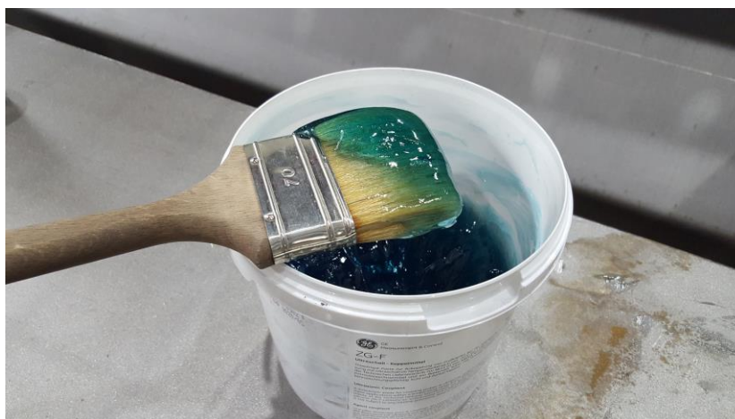
Slika 51: Gel za bolji i glađi kontakt sonde s površinom
