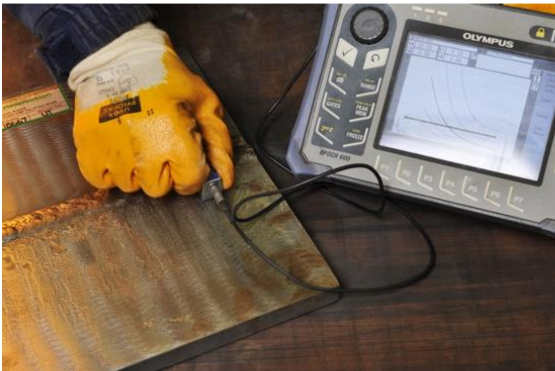
Slika 16: Ultrazvučno ispitivanje zavarenog spoja [16]
