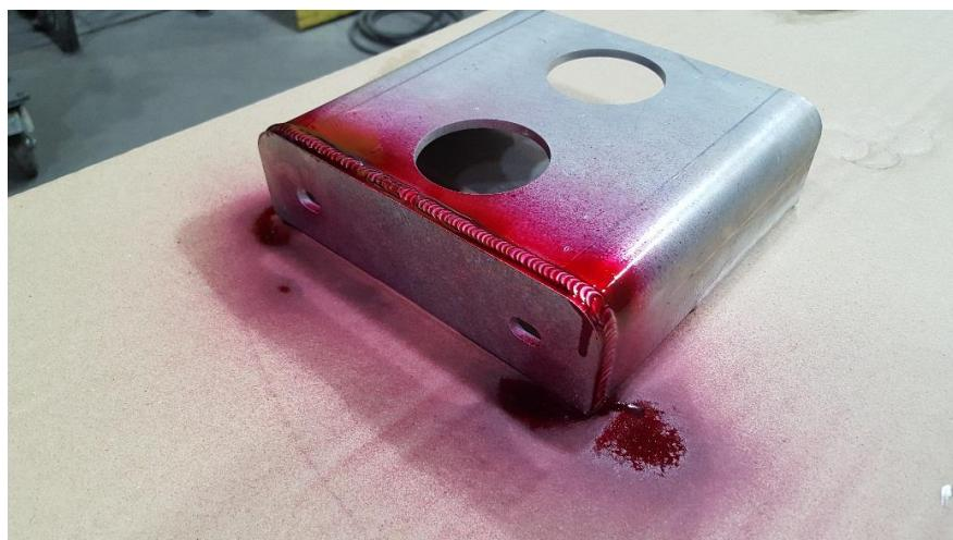
Slika 33: Ispitivanje zavarenog spoja penetrantima (faza nanošenja penetranta)
