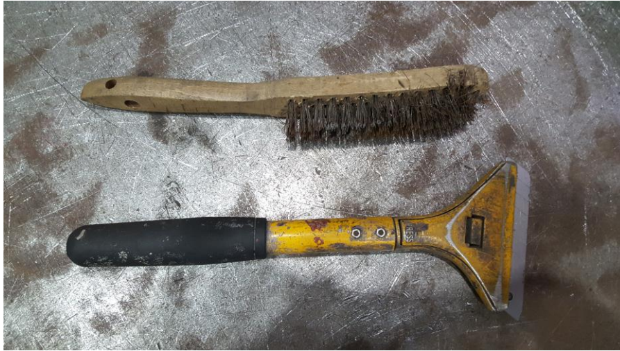
Slika 52: Alat za čišćenje površine
