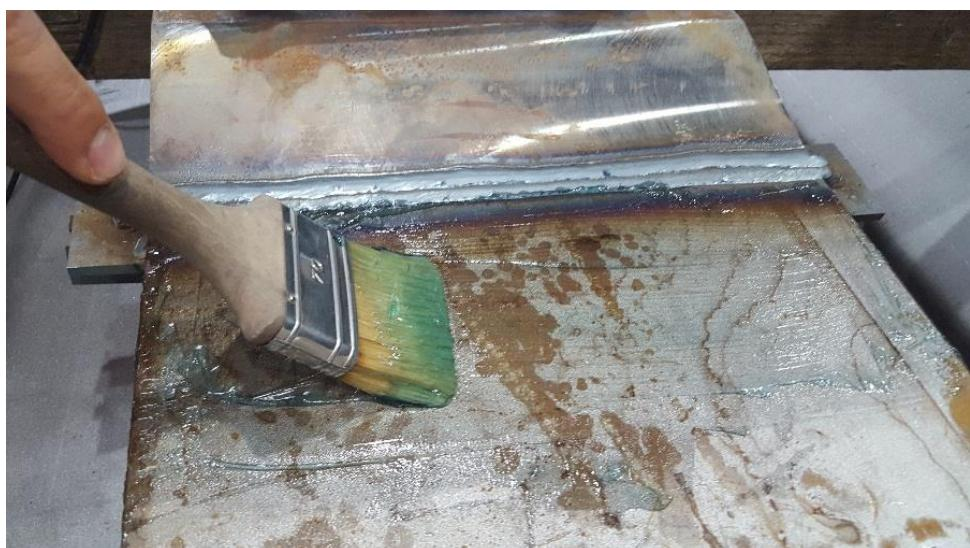
Slika 58: Premazivanje površine gelom
