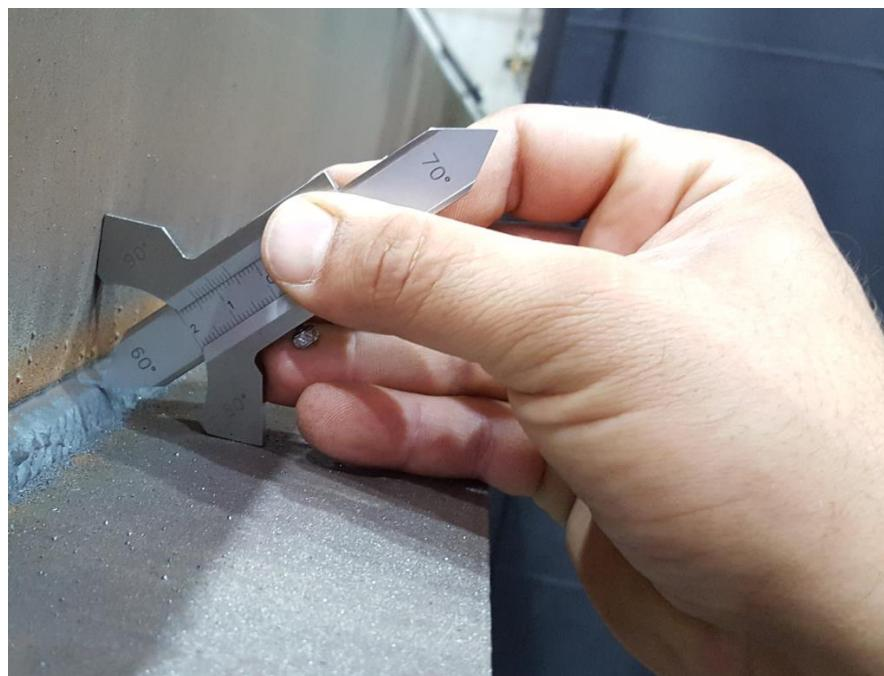
Slika 29: Mjerenje veličine zavarenog spoja
