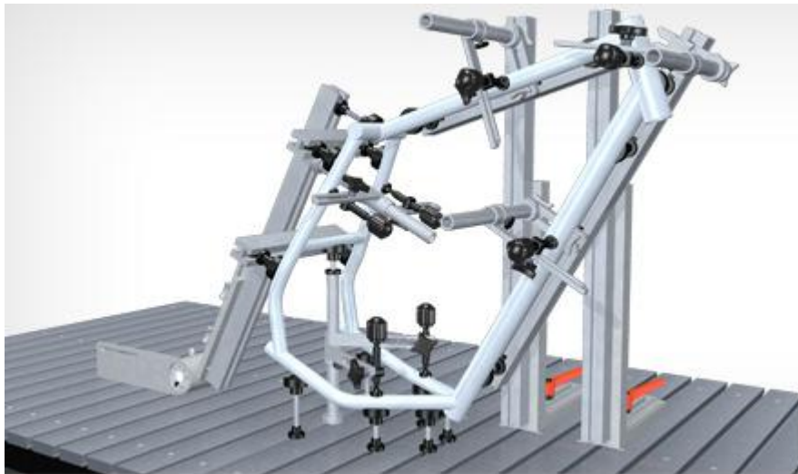
Slika 8.2.2 3D sustav za stezanje [31]
