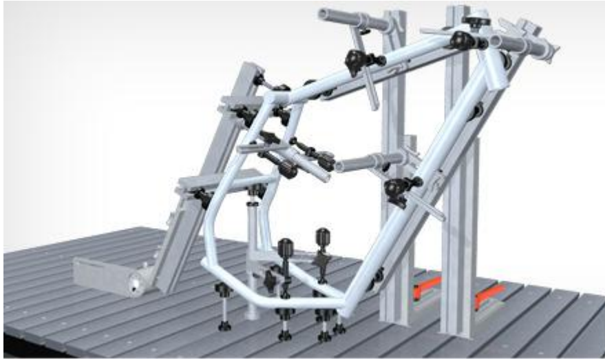
Slika 8.2.2 3D sustav za stezanje [31]
