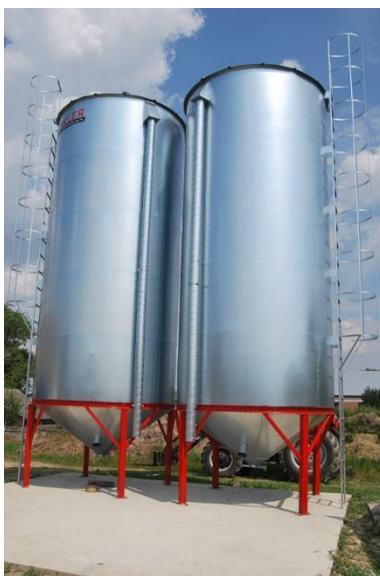
Slika 1. Silosi sa konusnim dnom
