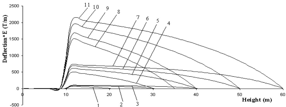
Slika 22. Prosječno izvijanje \*  $E$  naspram visine za silose različitih dimenzija. ( $Ep = 20 \text{ cm}$ ).
