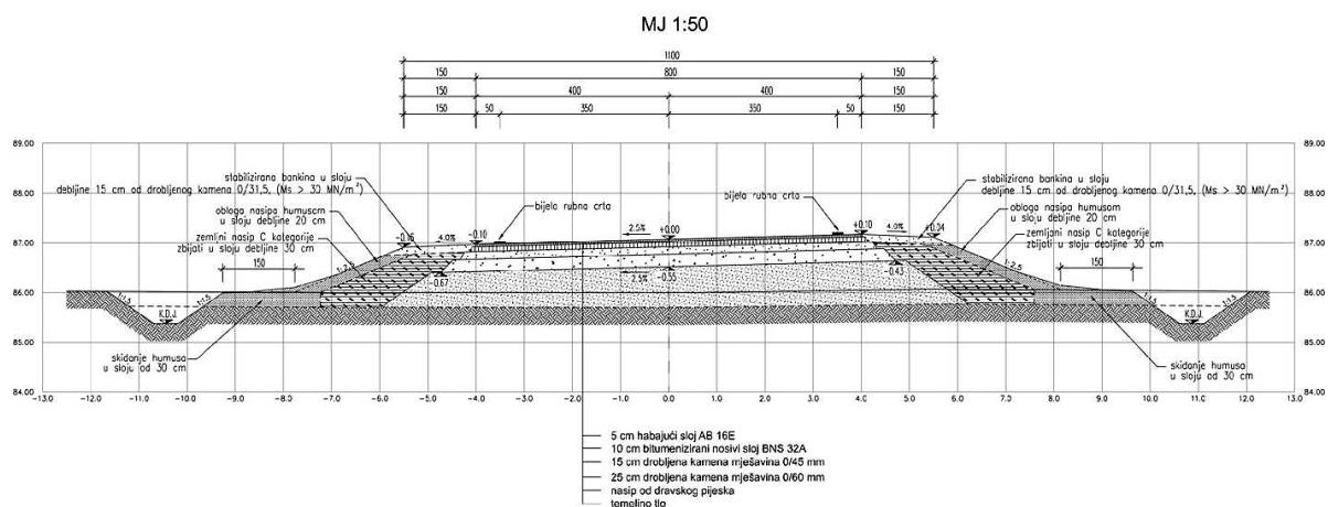
Slika 6 Poprečni presjek trase ceste u niskom nasipu
