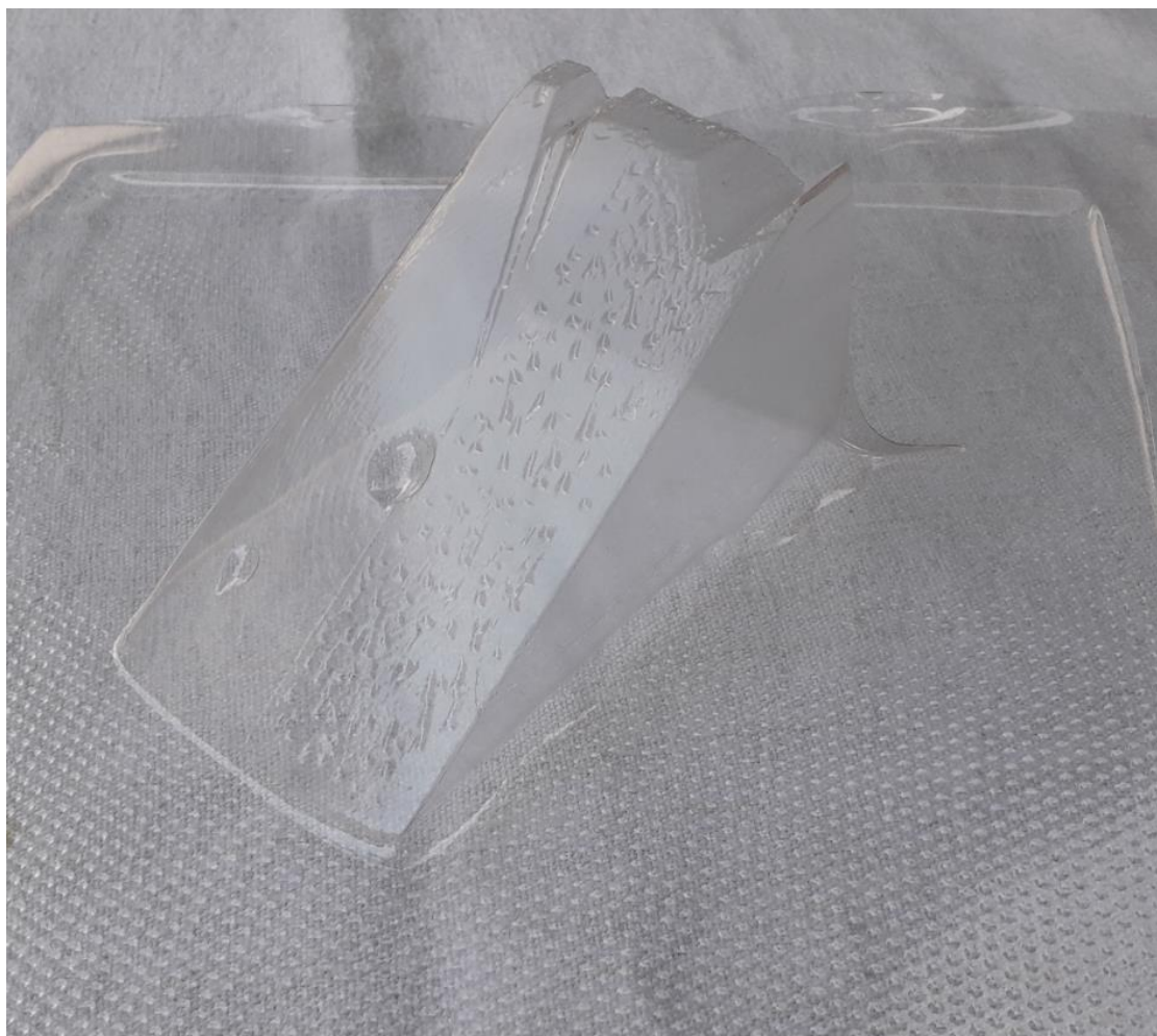
Slika 4.16 Treći uzorak, t = 90 s, debljina folije = 0,5mm
