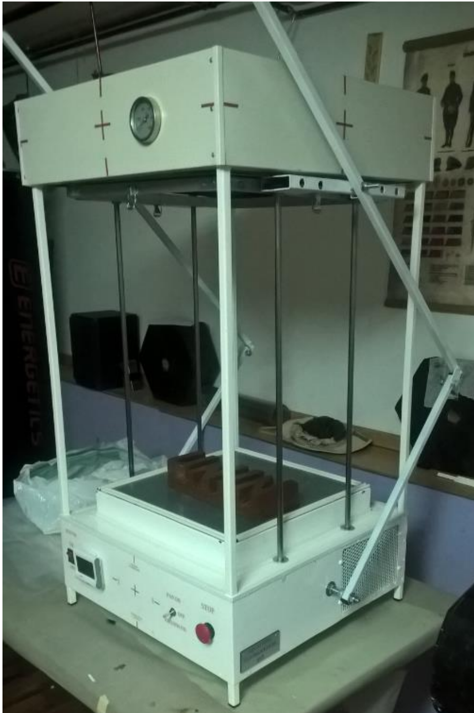
Slika 3.5 Uređaj za vakuumsko toplinsko oblikovanje polimera
