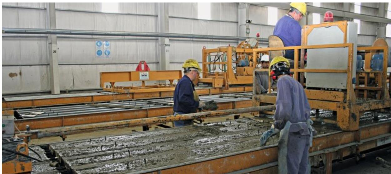
Slika 4.6 Poravnavanje betona nakon zalijevanja
