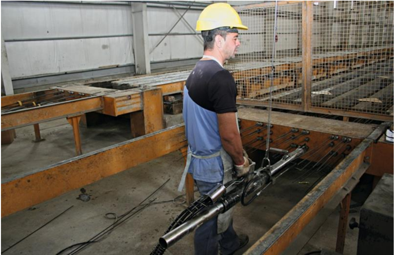
Slika 4.4 Hidraulička preša za zatezanje žica
