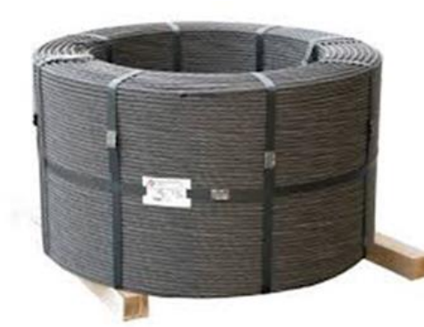
Slika 2.4 Čelik za prednaprezanje
