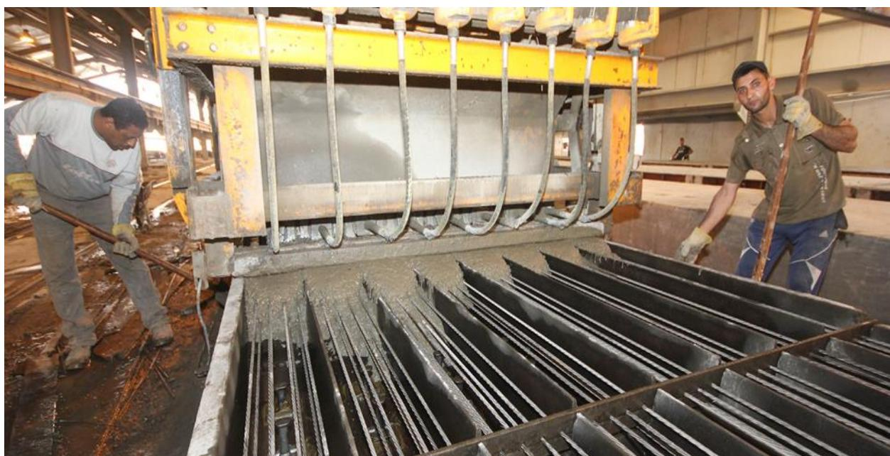
Slika 4.5 Ulijevanje betona u kalupe nakon zatezana žica
