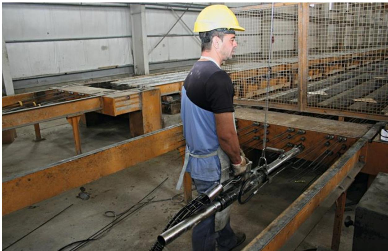
Slika 4.4 Hidraulička preša za zatezanje žica
