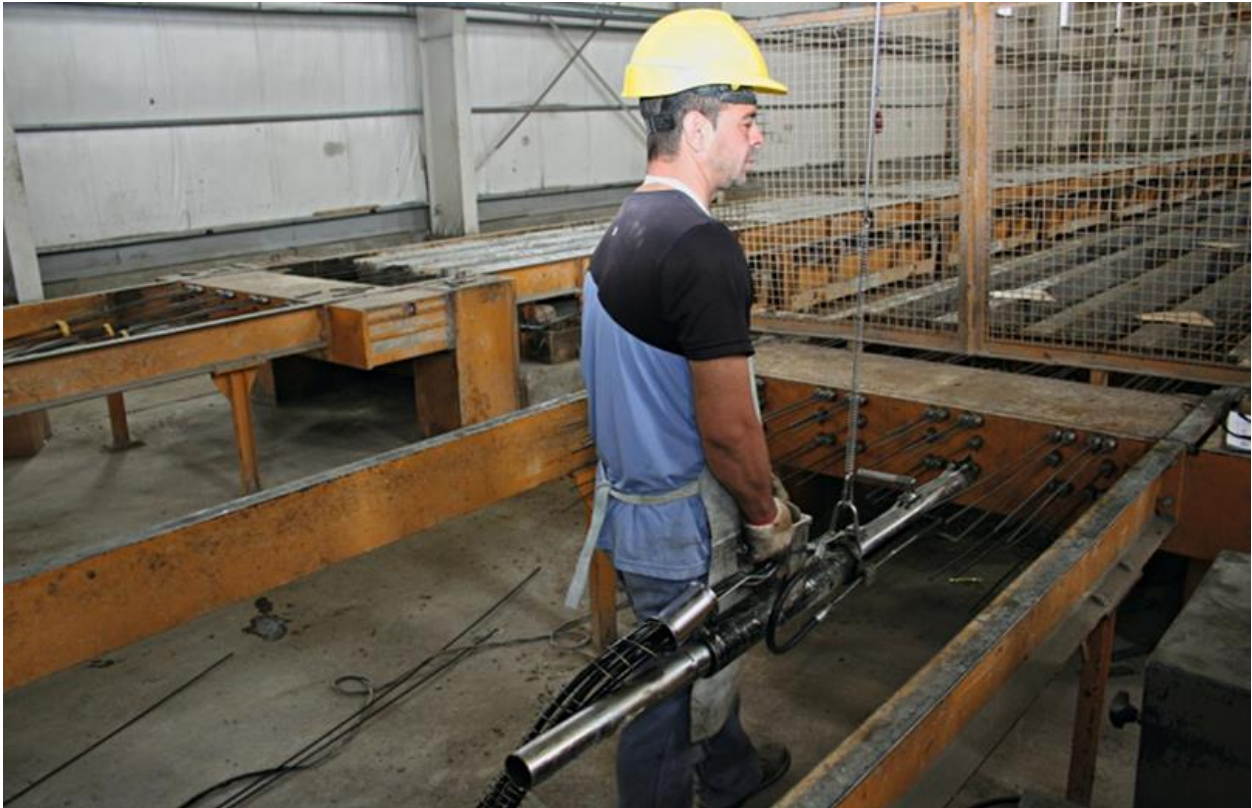
Slika 4.4 Hidraulička preša za zatezanje žica
