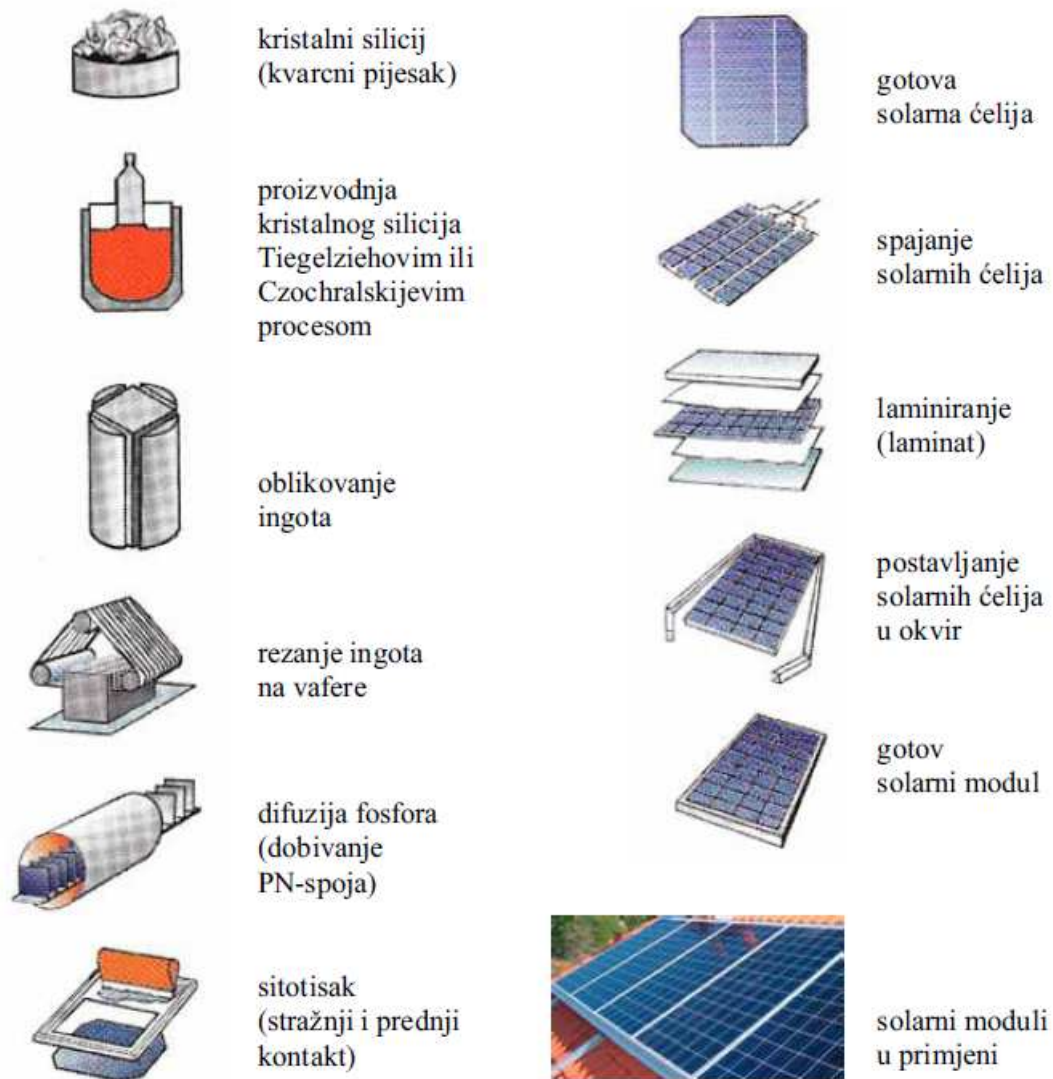
Slika 2.5. Postupak proizvodnje FN ćelije od kristalnog silicija
