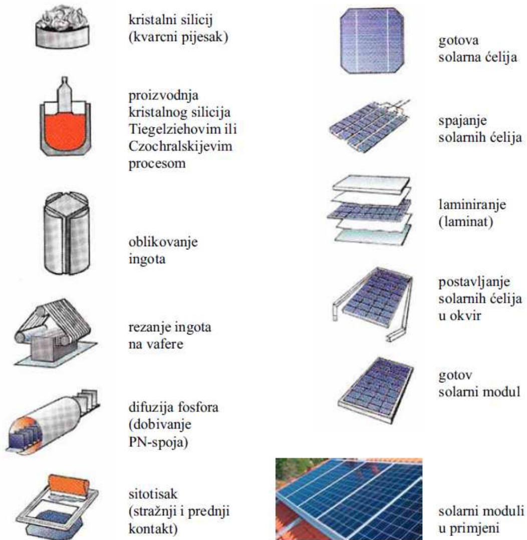
Slika 2.5. Postupak proizvodnje FN ćelije od kristalnog silicija
