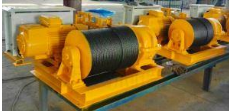
Slika 3.22: Bubanj za namatanje užadi [19]
