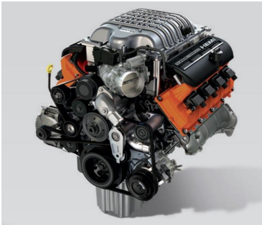
Slika 34. Mehanički pogon kompresora [18]
