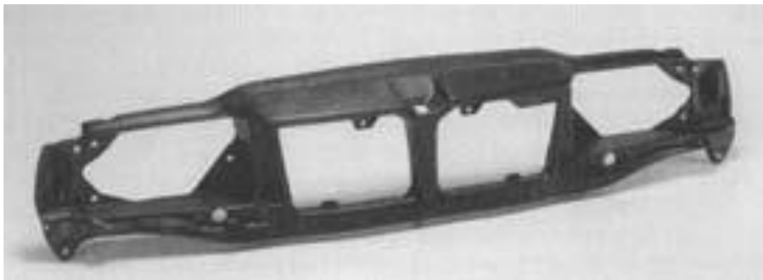
Slika 23. Prednji dio Volva 850, PP ojačan staklenim vlaknima [11]
