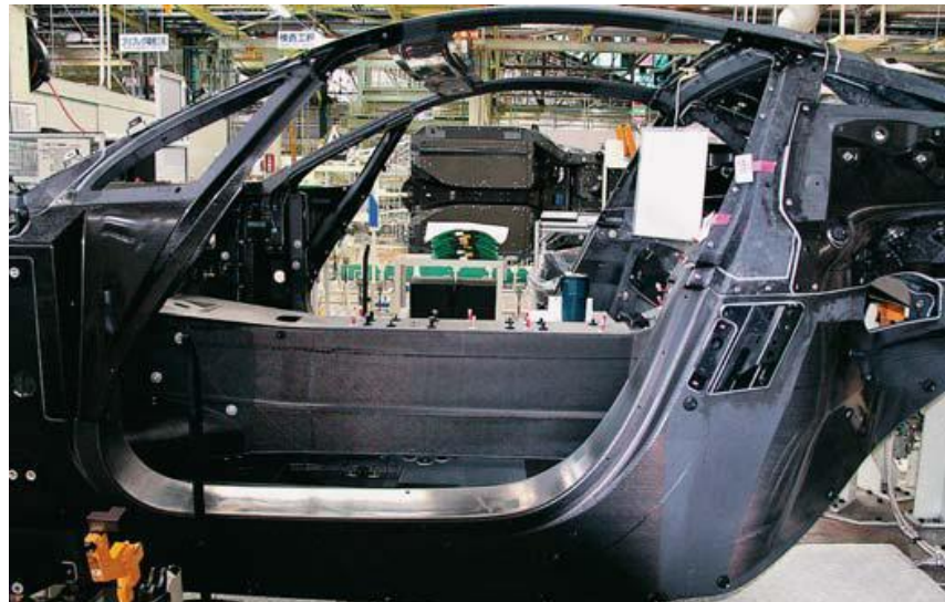
Slika 42. Karoserija Lexusa LFA [3]
