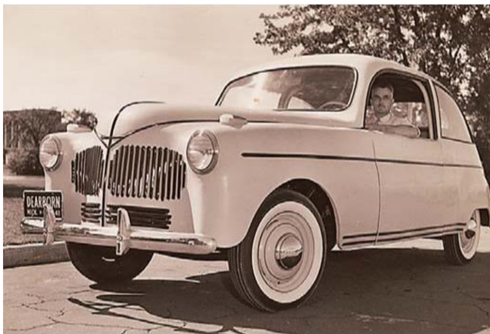
Slika 1. Fordov automobil od duromernog kompozita s konopljom [3]
