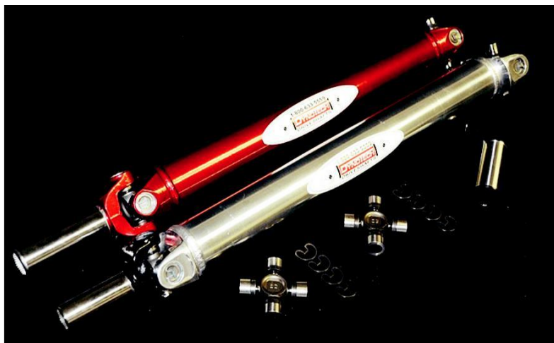
Slika 31. Kardansko vratilo Chevrolet Corvette [15]
