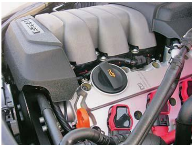
Slika 48. Poklopac glave motora kod motora 3,2 FSI [3]
