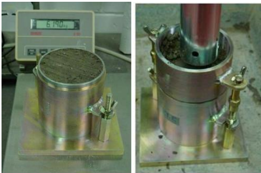
Slika 4.6. Zbijanje Proctorovim aparatom
