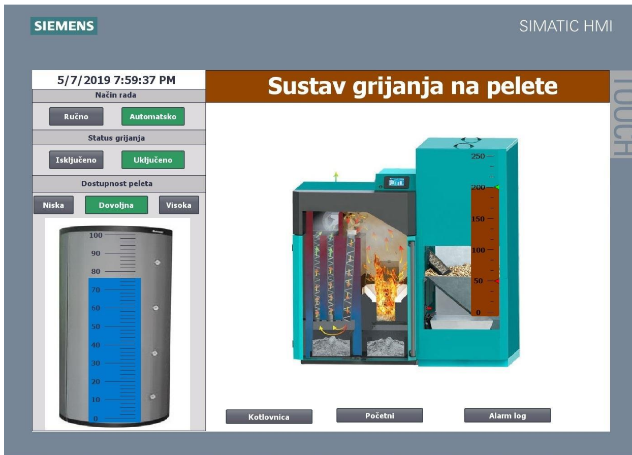
Slika 5.7 Sustav grijanja na pelete
