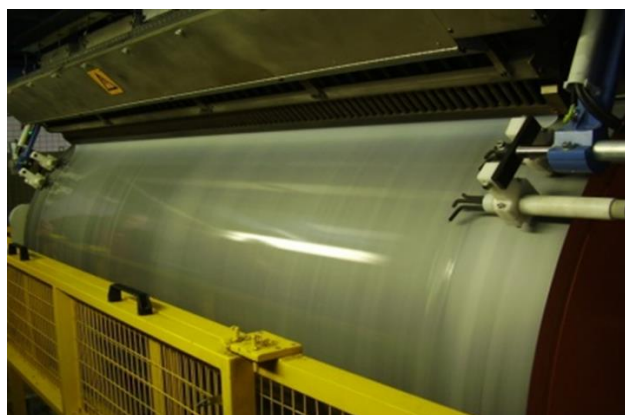
Slika 10. proces hlađenja sloja filma na valjku za hlađenje
