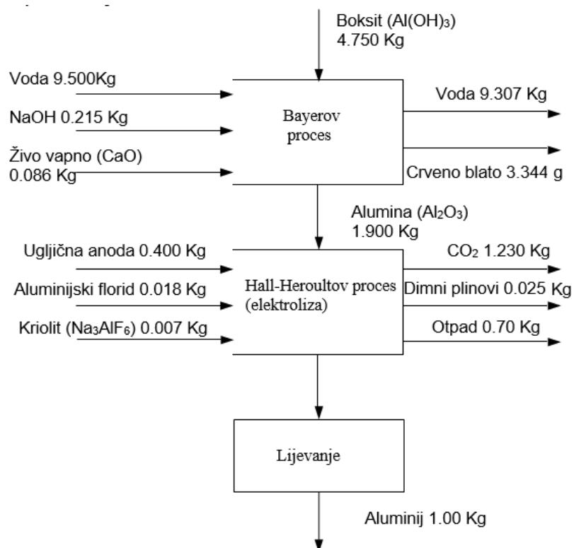
Slika 2.4. Primarni aluminijski proizvod od sirovog materijala
