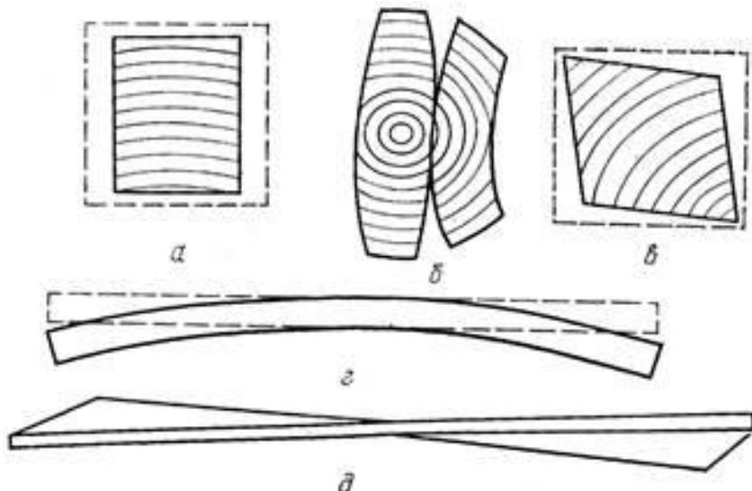
*Slika 1.5. Vrste savijanja: a, c - mijenjaju oblik trake poprečnog presjeka s različitim rasporedom slojeva na kraju; b - promjena oblika poprečnog presjeka ploča (jezgra i strane); r - uzdužni zavarenost; d - wingedness*
