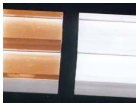
*Slika 3.3. PVC uzorak prije (desno) i nakon (lijevo) UV ispitivanja*
