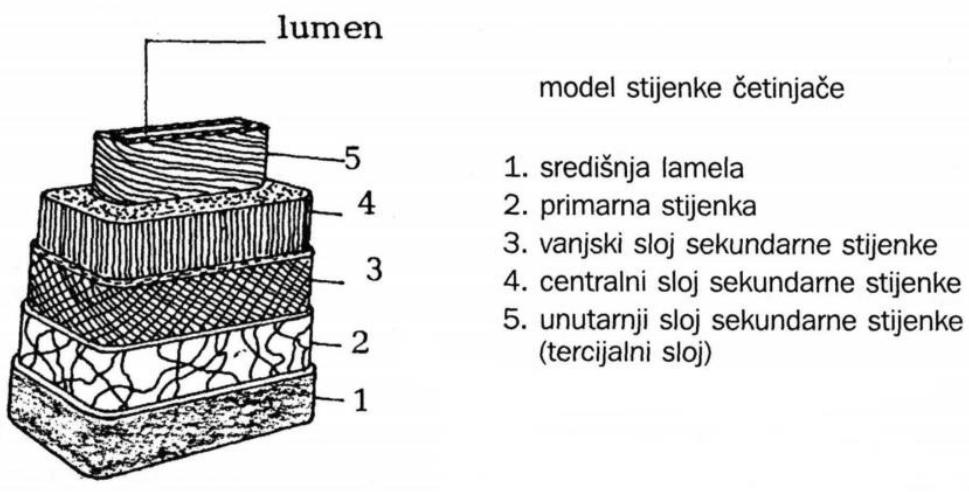
Slika 1.1. Prikaz slojeva drva na primjeru stjenketraheide četinjače
