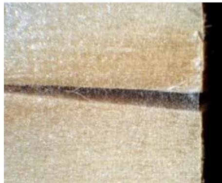
*Slika 3.2. Otvaranje pukotina u uzorku drva nakon cikličkog ispitivanja*
