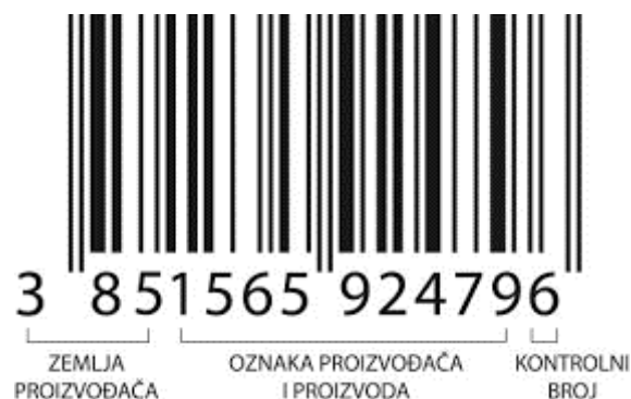
Slika 6. Struktura bar koda
