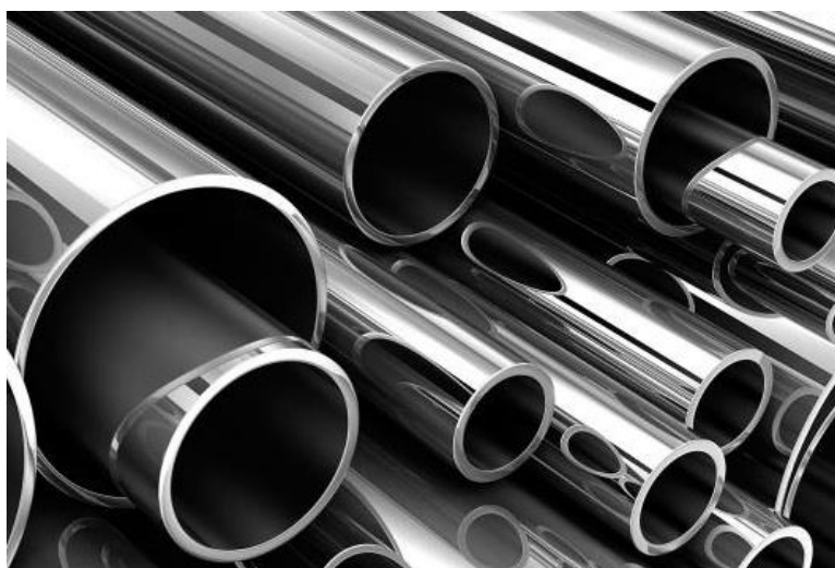
Slika 2.5 Cijevi izrađene od austenitnog korozijski postojanog čelika [22]
