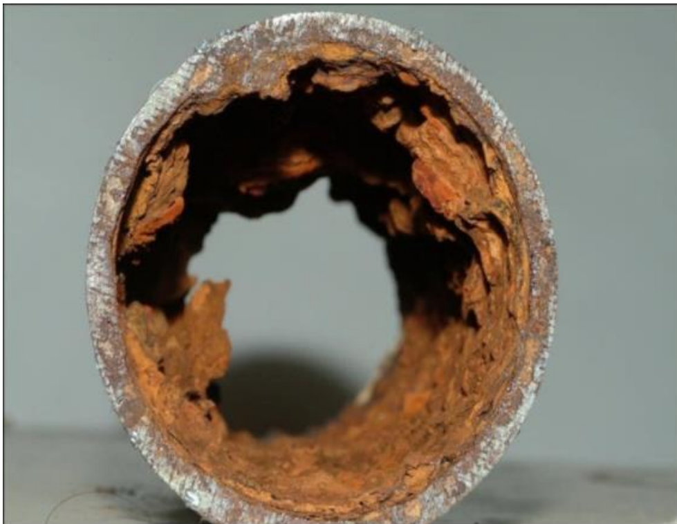
Slika 1.2 Kemijska korozija u cijevima [8]
