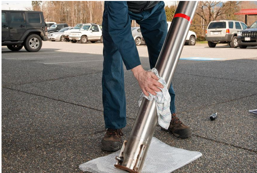
Slika 3.3 Čišćenje korozijski postojanog čelika brisanjem [37]
