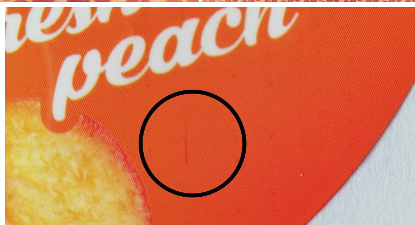
Slika 7.9 Otisak s oštećenim raketom
