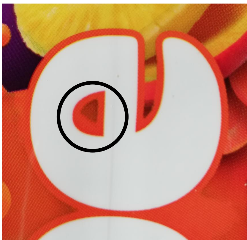
Slika 7.5 Uzorka br. 3 - izgled rastera nakon 500.000 otiska
