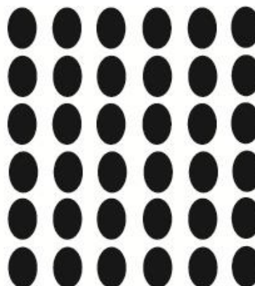
deformacija rasterskog elementa u tisku "efekt smicanja"
