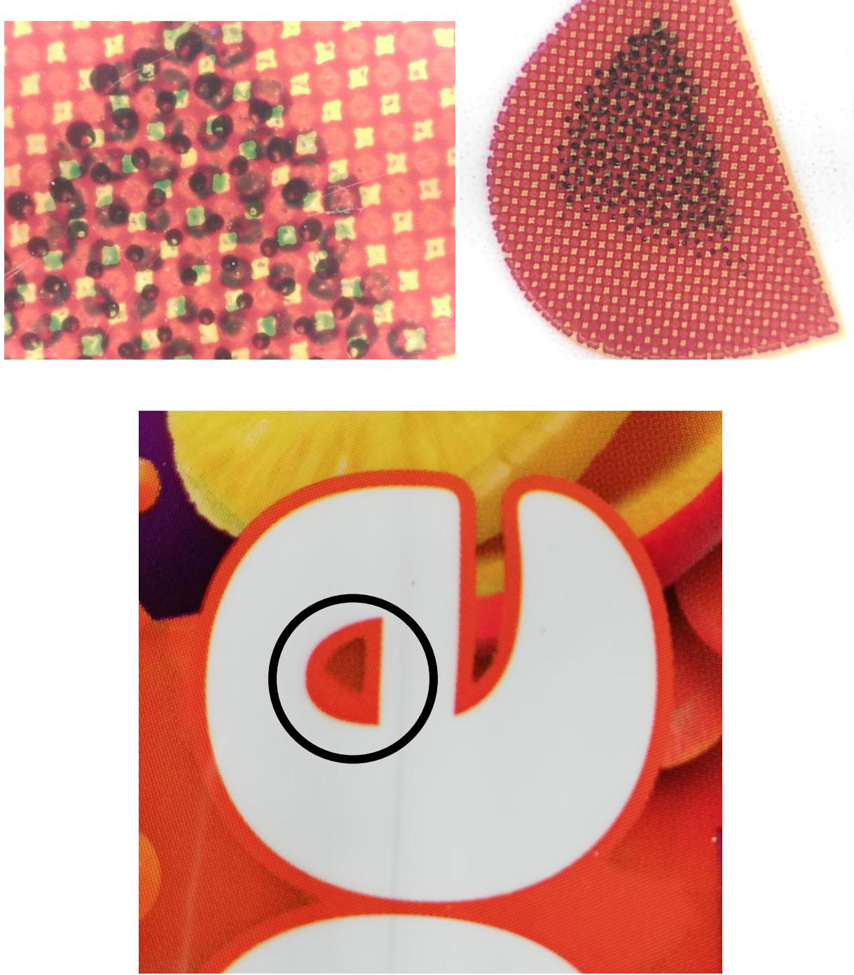
*Slika 7.5 Uzorka br. 3 - izgled rastera nakon 500.000 otiska*
