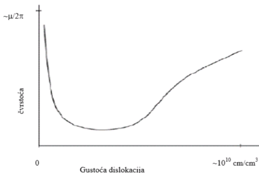
Dijagram 3.3 Ovisnost čvrstoće materijala o gustoći dislokacija [21]
