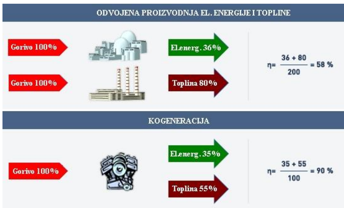
Slika 1.1: Prednost kogeneracije pred odvojenom proizvodnjom električne energije
