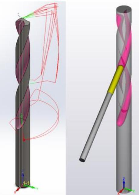
Slika 8.12 Putanja alata i simulacija obrade
