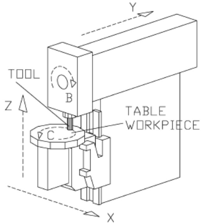
Slika 4.4 rotirajući alat i rotirajući stol [10]
