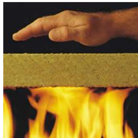
Slika 4.2 Niska toplinska provodljivost mineralne vune
