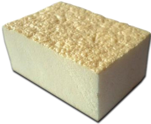
Slika 4.8 Poliuretanska pjena proizvedena u kalupu
