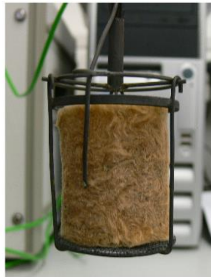
Slika 5.5 Uzorak kamene vune prije i poslije ispitivanja (promjena mase od 3,7%)
