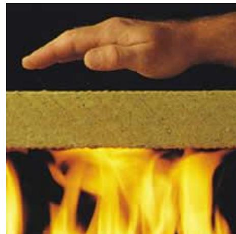
*Slika 4.2 Niska toplinska provodljivost mineralne vune*
