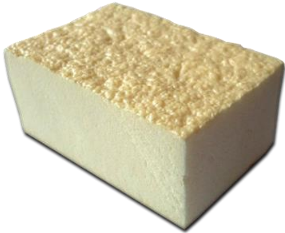
Slika 4.8 Poliuretanska pjena proizvedena u kalupu
