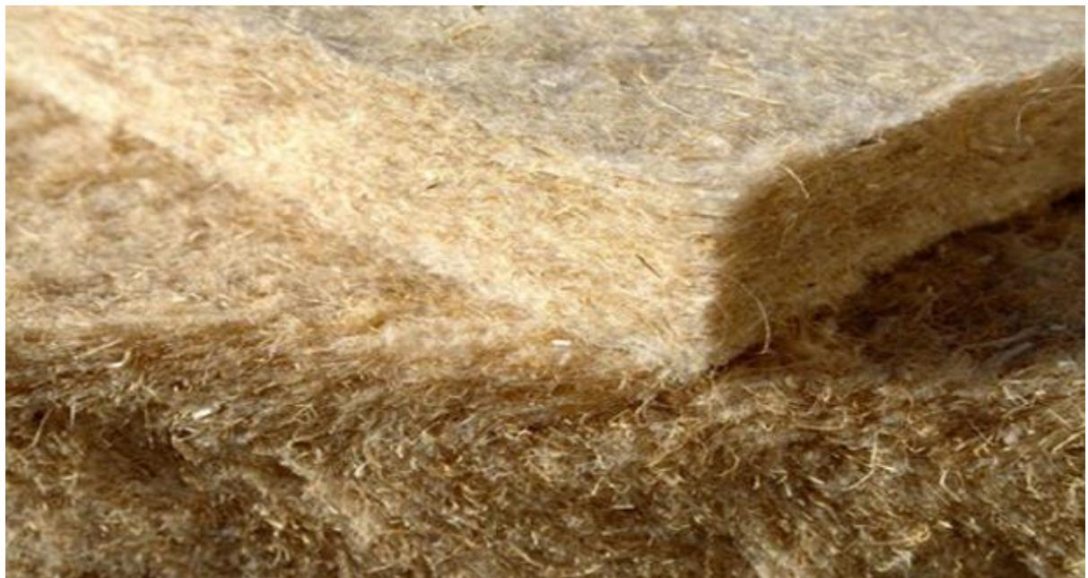
*Slika 4.22 Izolacijske ploče od konoplje*
