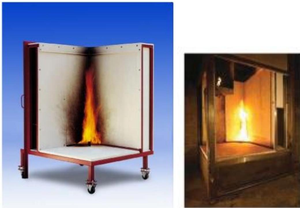
*Slika 5.1 Aparatura za provođenje ispitivanja prema SBI metodi*
