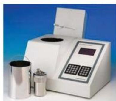
*Slika 5.3 Aparatura za provođenje ispitivanja prema EN ISO 1716 metodi*
