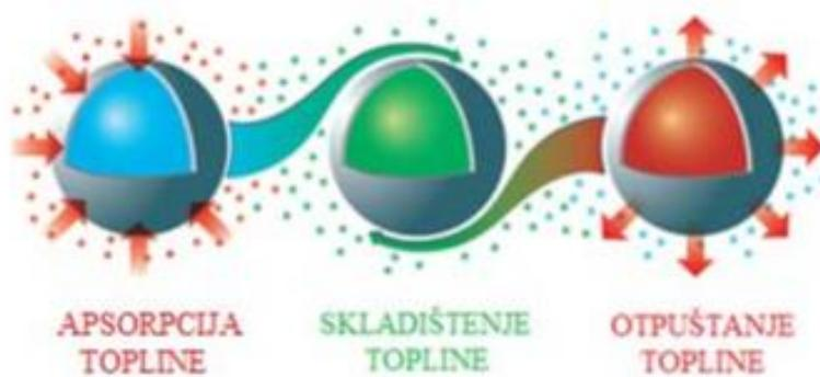
*Slika 4.34 Mehanizam rada PCM-a*
