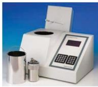
Slika 5.3 Aparatura za provođenje ispitivanja prema EN ISO 1716 metodi
