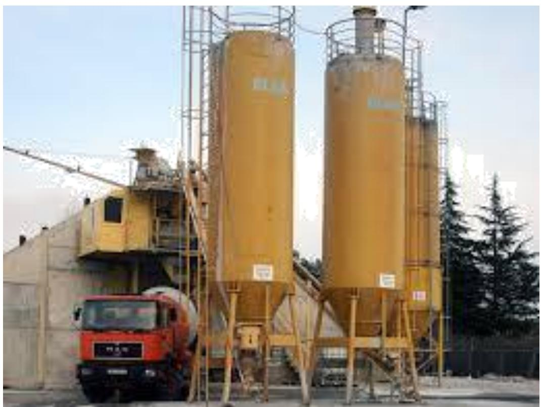
Slika 3.8.1. Betonara Tehnobeton
