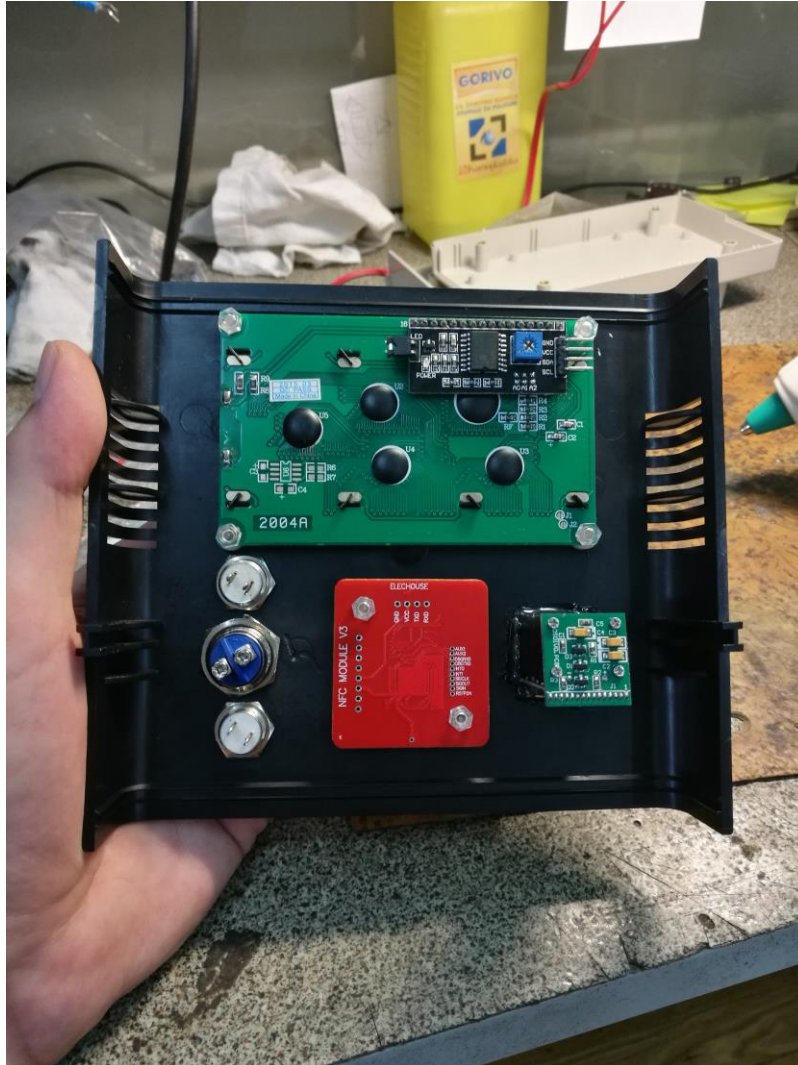
Slika 8: Montaža dijelova na prednju stranu kućišta
