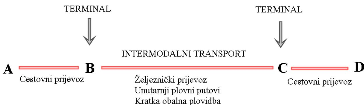
*Slika 4. Odvijanje kombiniranog transporta*
