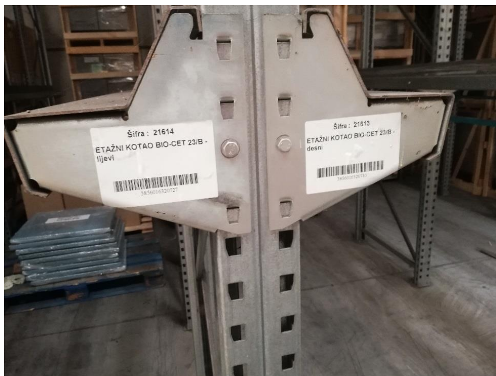
Slika 22 Primjer označavanja skladišnog prostora pomoću barkodaova radi lakšeg snalaženja i lakše inventure
