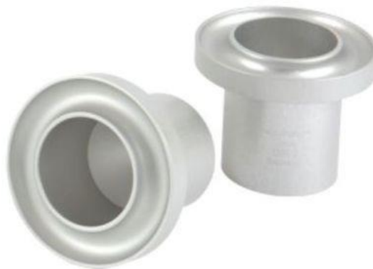
Slika 15; čaše za mjerenje viskoznosti; [31]
