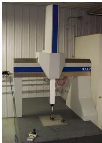
Slika 4.3. Konstrukcija koordinantnog mjernog uređaja [1]
