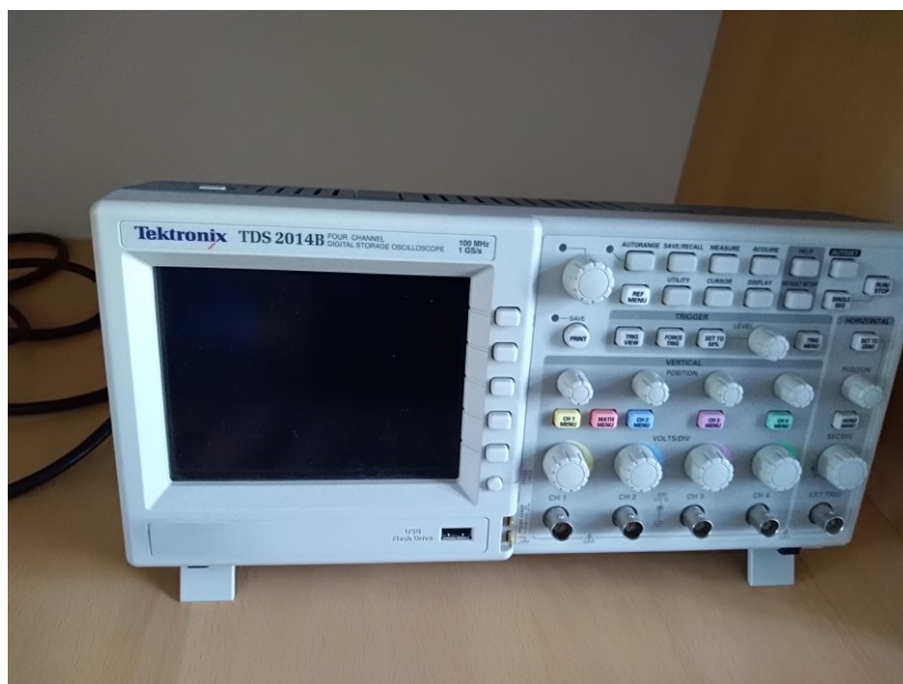
Slika 5.2 Osciloskop Tektronix TDS 2014
