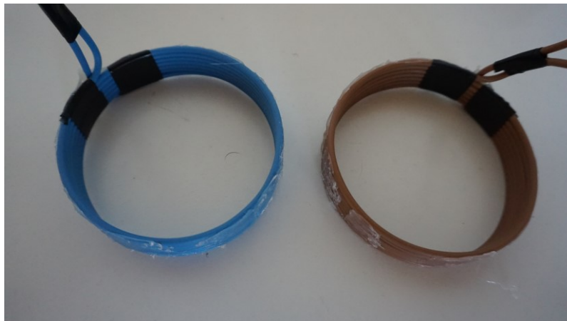
Slika 5.5 Primarna i sekundarna zavojnice
