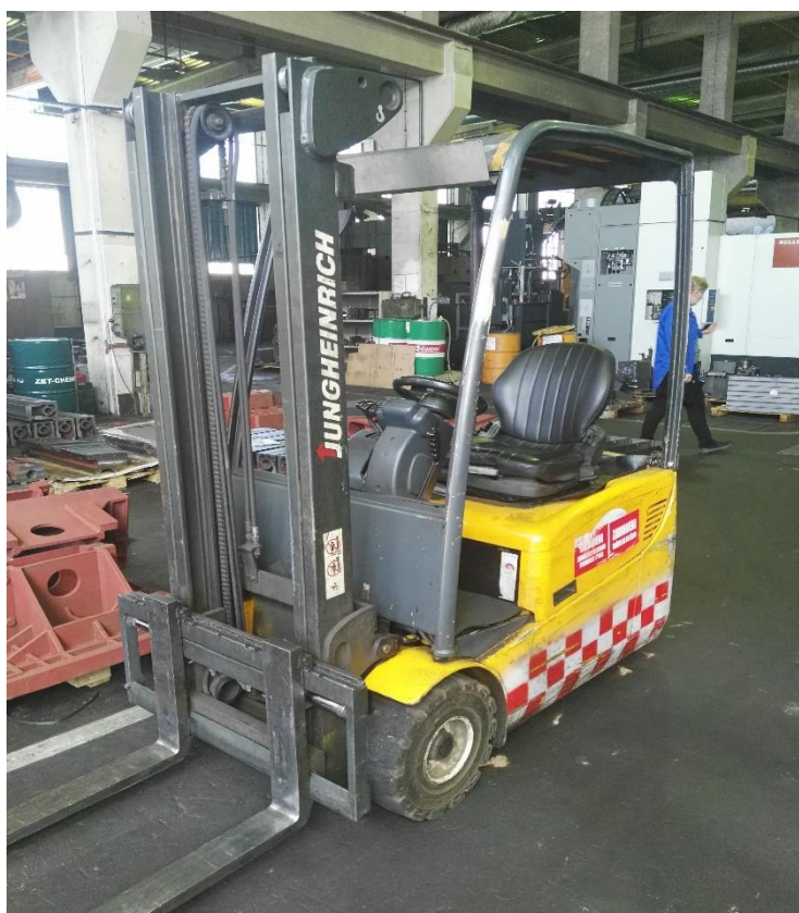
Slika 26. Električni čeonu viličar Jungheinrich EFG 115
