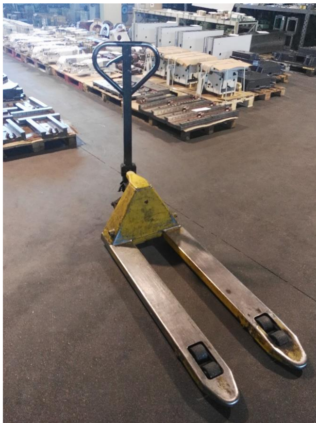
Slika 25. Ručni viličar Liftex Elite 20
