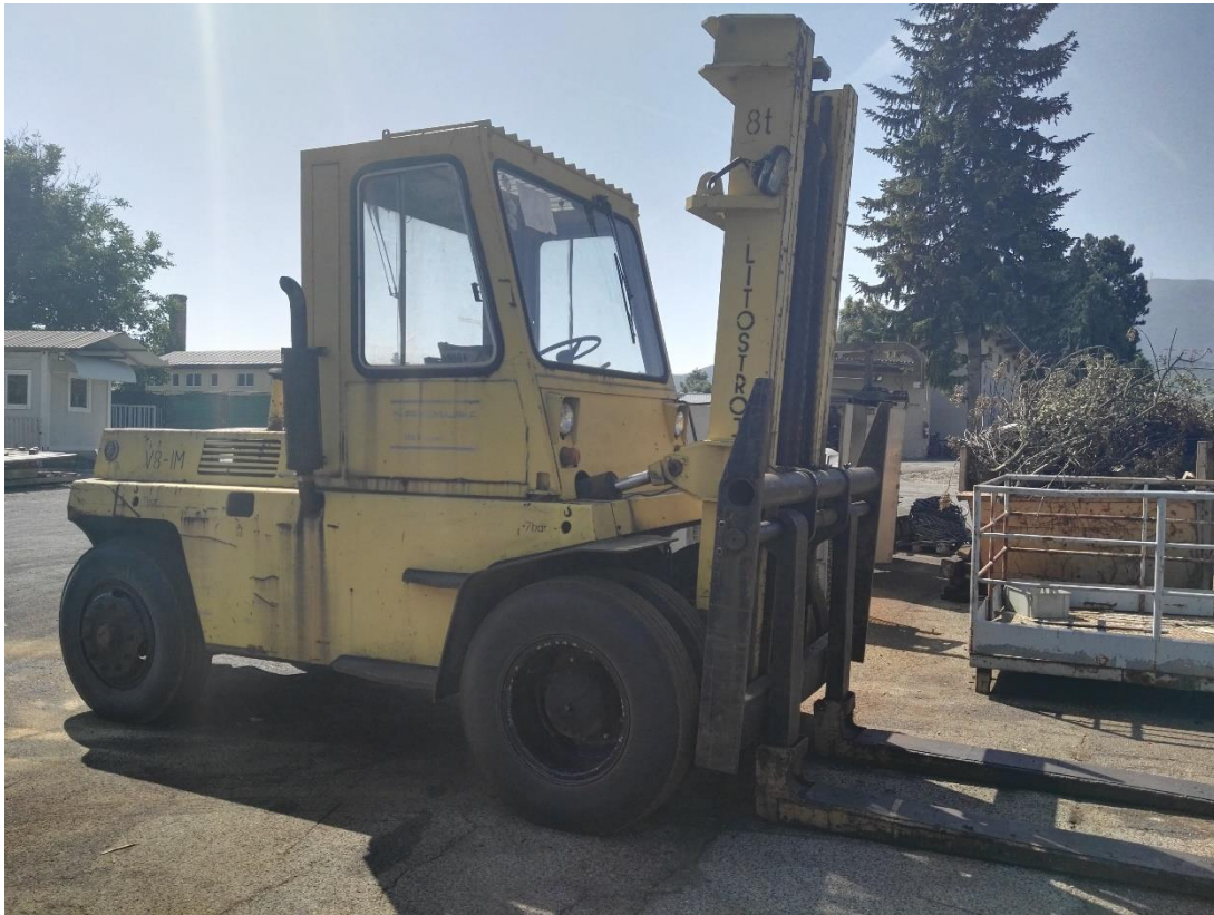
Slika 28. Dizel viličar Litostroj 8t
