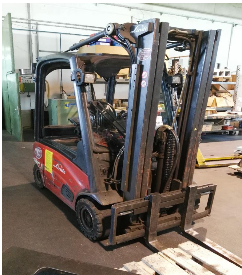
Slika 27. Električni čeoni viličar Linde E16
