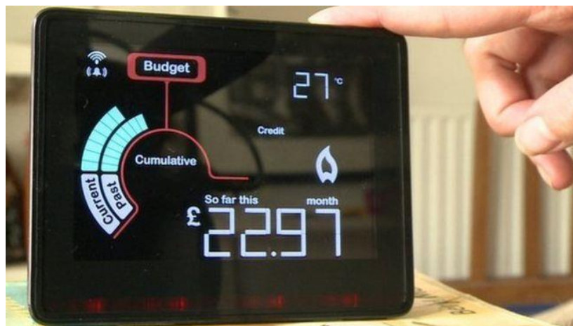
Slika 2.1. Uređaj za kontrolu potrošnje energije u kućanstvu
