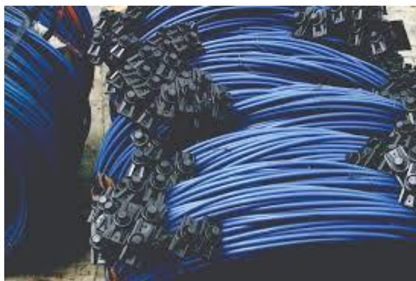
Slika 2.6. Unbonded kabeli u kolotovima
