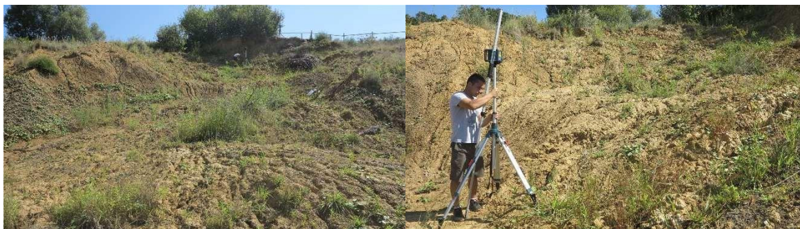
Slika 7.6. Mjerenje karakterističnih nagiba u zoni bušotine B11
