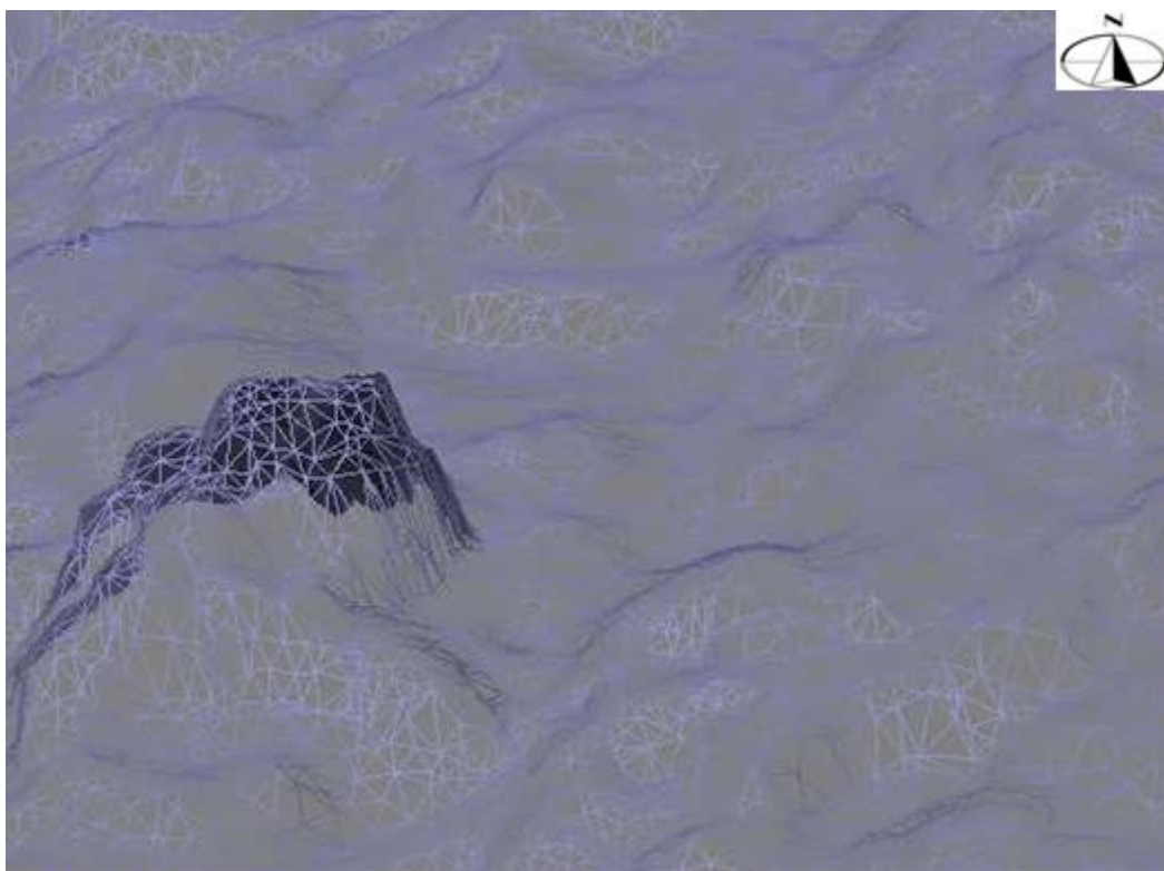
Slika 5.1. TIN struktura kod 3D modeliranja [1]
