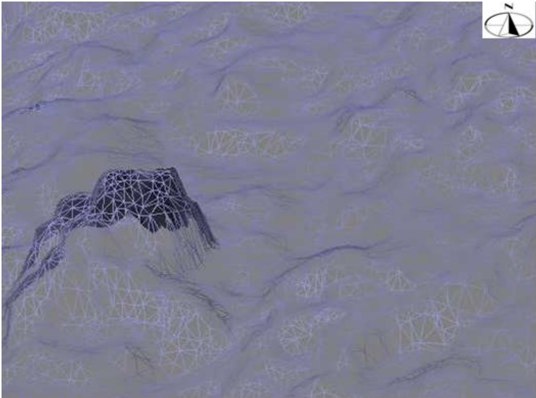
Slika 5.1. TIN struktura kod 3D modeliranja [1]
